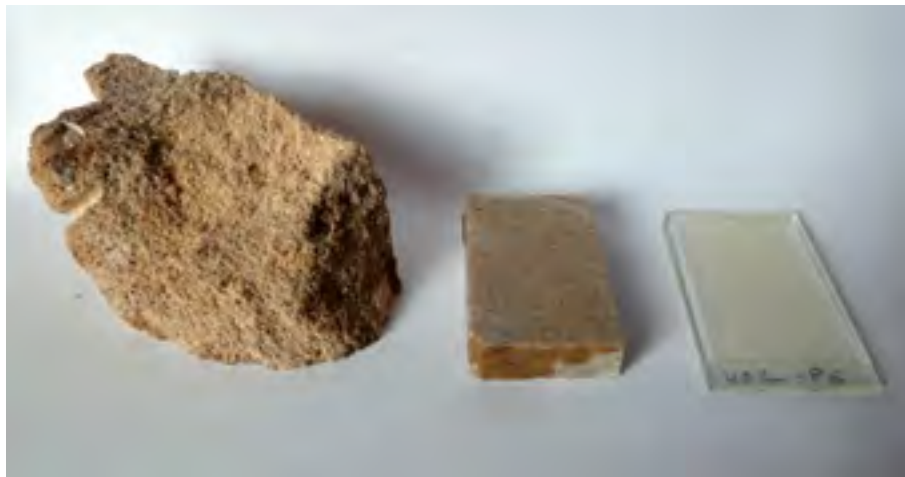
Figure 285 : De l'échantillon de roche à la lame mince (cl. : A. Polinski).
