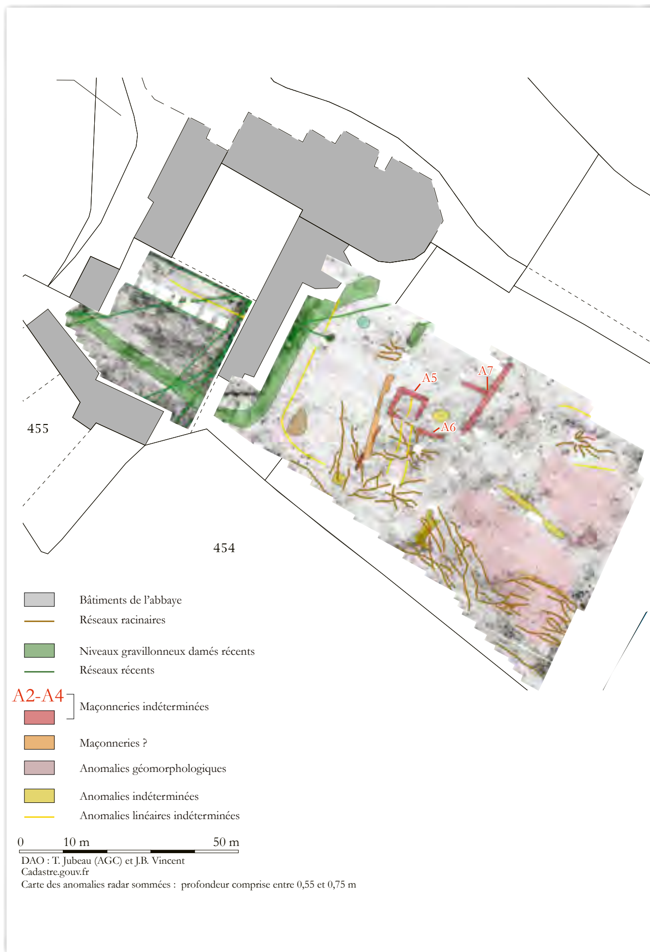
Figure 173 : Hambye (50), abbaye d'Hambye – Anomalies décelées au radar.
