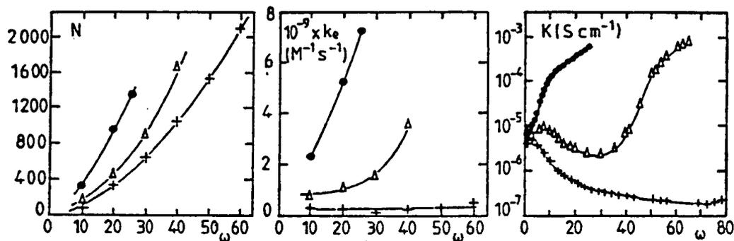
**FIGURE 3 :** Variations du nombre d'agrégation  $N$  du tensioactif, de la constante de vitesse  $k_e$  et de la conductivité électrique  $K$  pour les microémulsions eau-chlorobenzène-chlorure d'alkyldiméthylbenzylammonium (chaîne alkyle à 12 (●), 14 (Δ) et 16 (+) atomes de carbone en fonction du rapport molaire [eau]/[tensioactif], à 20°C et [tensioactif] = 0.27M
