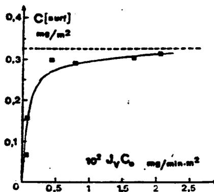
FIG. 7(a) : Adsorption du polyacrylamide sur un aluminosilicate  $\tau$  calculé = 200 mn
