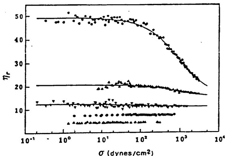
Figure 5 : Variation de la viscosité relative en fonction de la tension de cisaillement pour un microlatex de copolymère acrylamide-acrylate de sodium ( $d = 62$  nm)  $\phi = 0.35$  ( $\Delta$ ) ;  $0.44$  ( $o$ ) ;  $0.48$  ( $\nabla$ ) ;  $0.52$  ( $\blacktriangle$ ) ;  $0.55$  ( $\bullet$ ). Les courbes sont le meilleur ajustement de l'équation de Krieger aux points expérimentaux.
