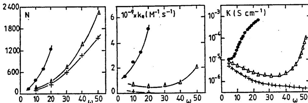
FIGURE 4 : Variations de  $N$ ,  $k_e$  et  $K$  avec le rapport molaire  $\omega = [\text{eau}]/[\text{tensioactif}]$  pour les microémulsions eau/chlorobenzène/bromure de dodecyltriméthylammonium/alcool(1-butanol ( $\Delta$ ); 1-pentanol (+) et 1-hexanol ( $\bullet$ )) à  $T = 20^\circ\text{C}$ ;  $[\text{alcool}]/[\text{tensioactif}] = 2,5$  et  $[\text{tensioactif}] = 0,27 \text{ M}$
