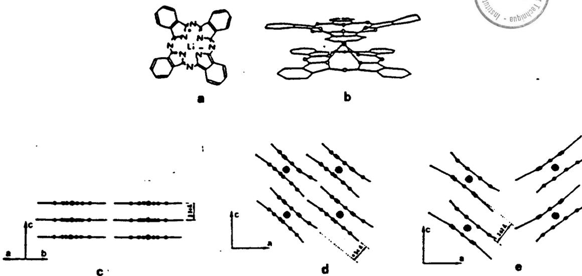
**Figure 1** : Structure moléculaire de deux phtalocyanines radicalaires : PcLi (a) et Pc<sub>2</sub>Lu (b). L'empilement moléculaire des différents systèmes étudiés est représenté schématiquement : PcLi (c) , Pc<sub>2</sub>Lu (d) et Pc<sub>2</sub>Lu.CH<sub>2</sub>Cl<sub>2</sub> (e).
