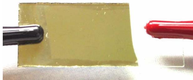
**Figure 3.18**: Photo d'une diode lumineuse multicouche. Le dispositif est basé sur celui présenté par M. Rubner (MIT 1995-1998). Cependant, nos dispositifs sont beaucoup plus grands et ils sont plusieurs fois plus efficaces grâce au positionnement précis d'une couche d'argile.
