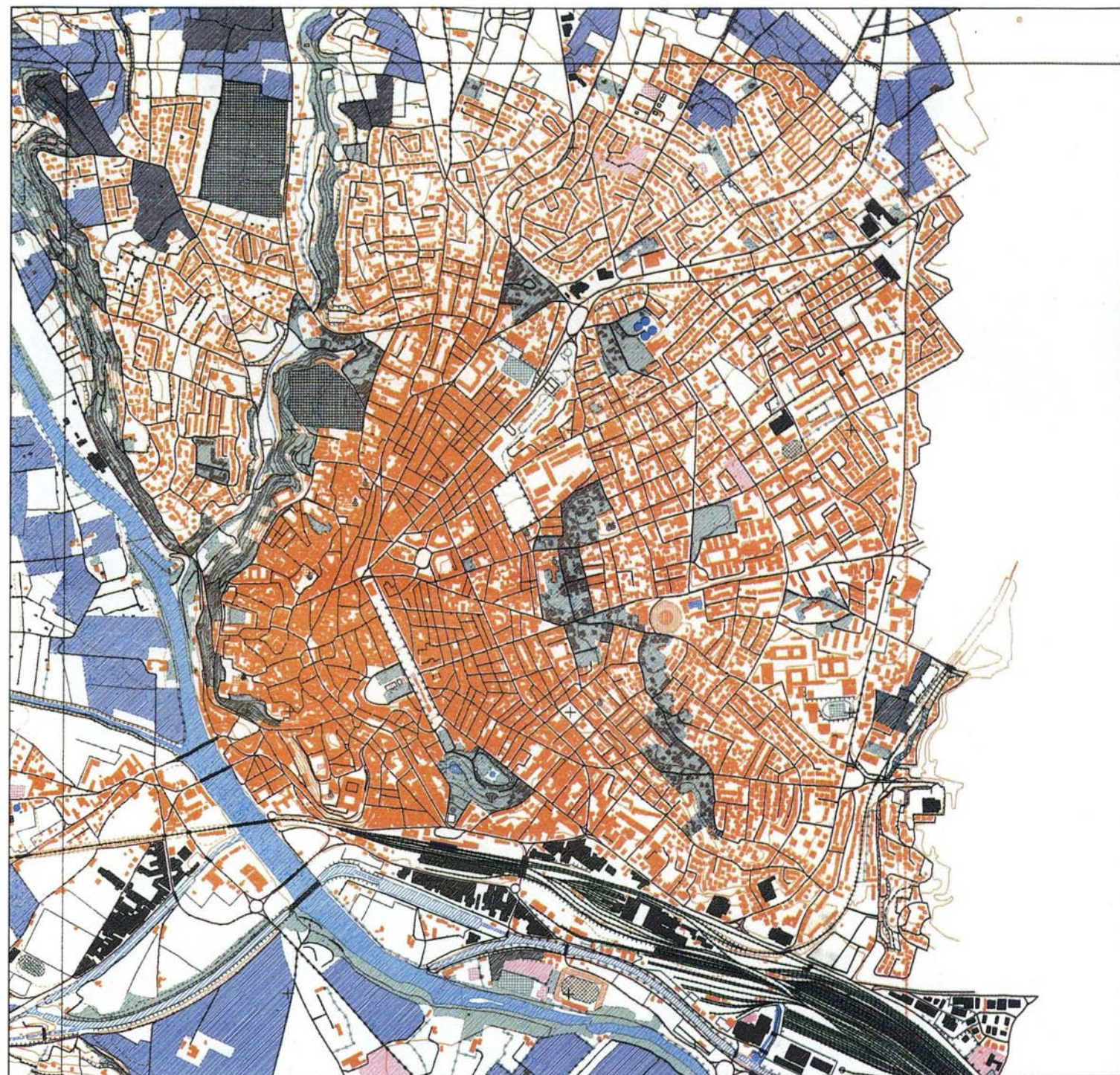
BÉZIERS : sortie brute à 1:20 000, après la phase restitution du processus de saisie BD TOPO.
