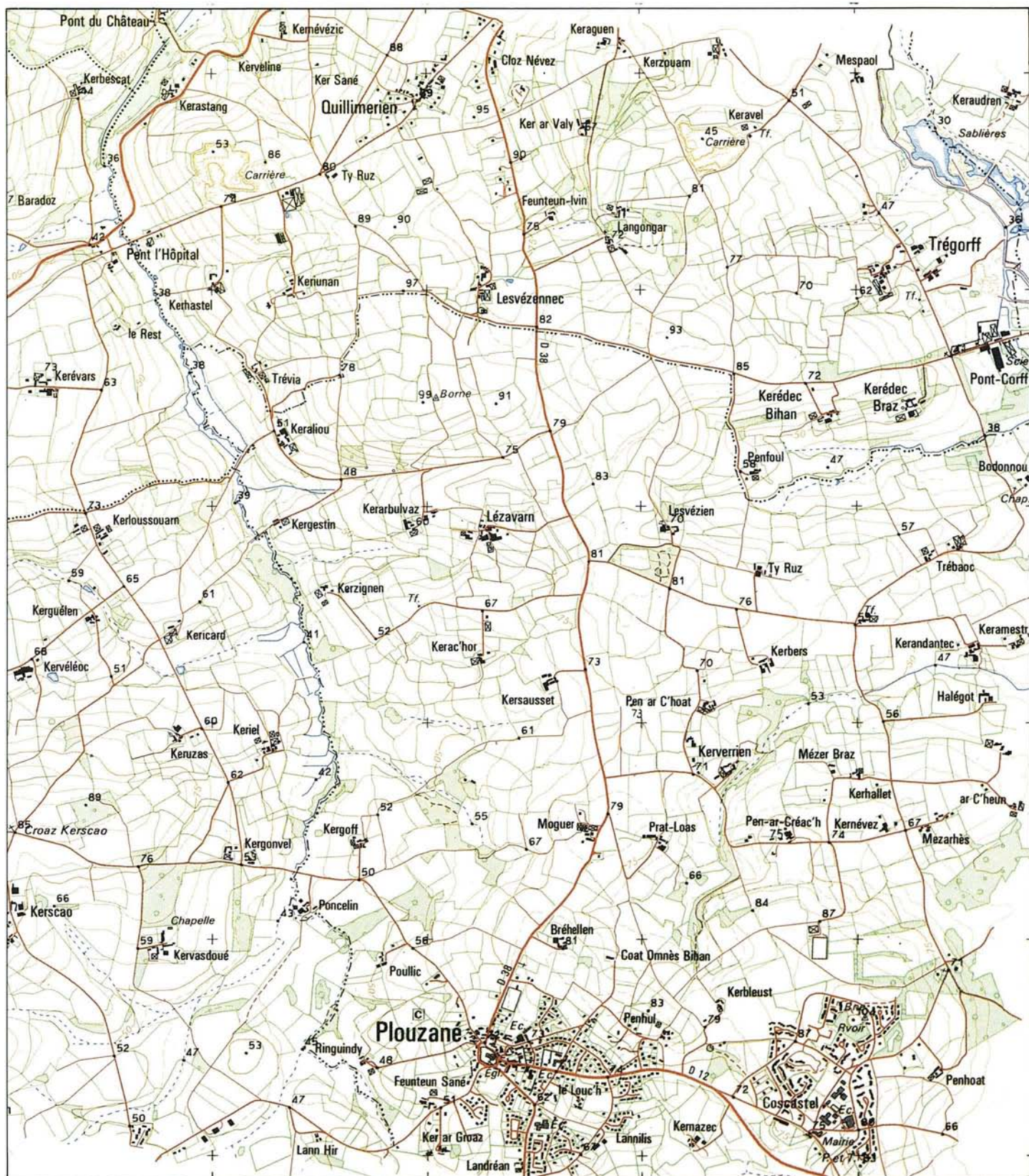
PLOUZANÉ : à partir d'une prise de vues à 1:30 000, premier essai expérimental de cartographie numérique à 1:25 000 proposé aux utilisateurs et à la CNIG en 1982.
