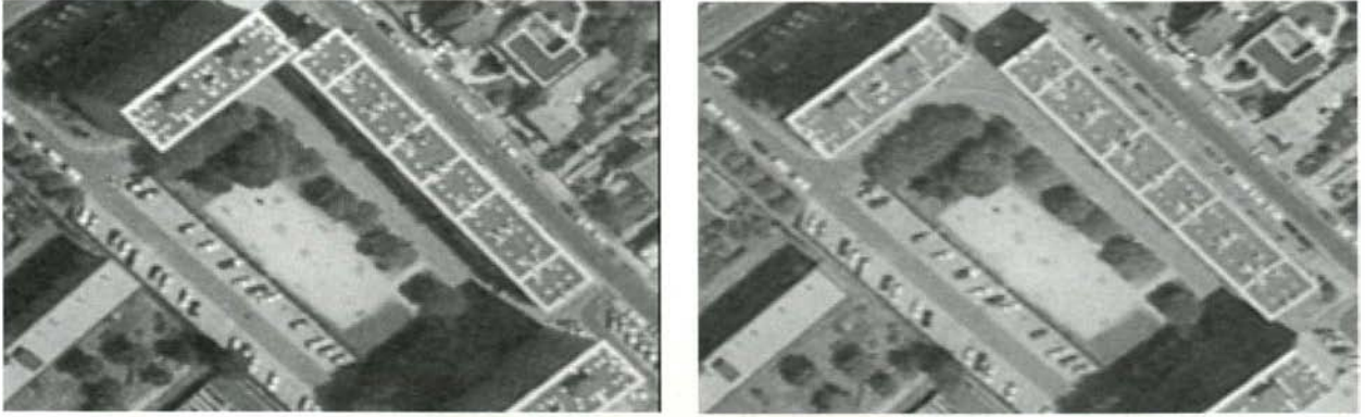
B.3.4.a : les images originales (320 x 240 pixels) ré-échantillonnées selon les lignes épipolaires,
