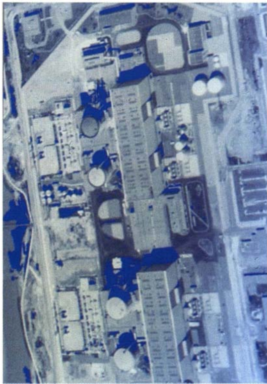
Détection des ombres : les ombres détectées permettront la validation du modèle de bâtiment calculé (recherche 93).
