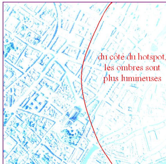
figure B.1.6 : mise en évidence de la valeur relative des ombres dans une image (plus clair = plus d'énergie)
