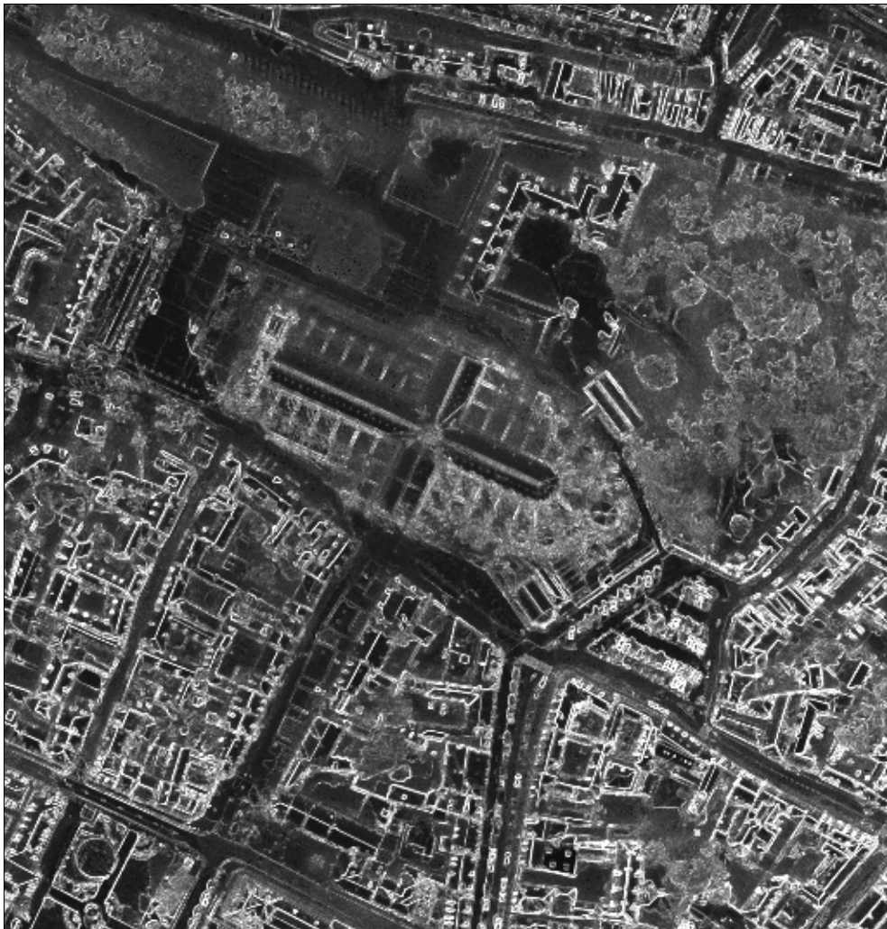
figure B.2.4 : image d'accumulation des gradients
