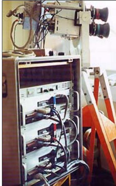
figure B.3.8 : les trois caméras (en arrière-plan) et leur électronique d'acquisition
