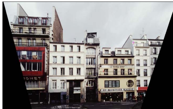
figure B.1.10 : redressement à l'aide des deux points de fuite principaux
