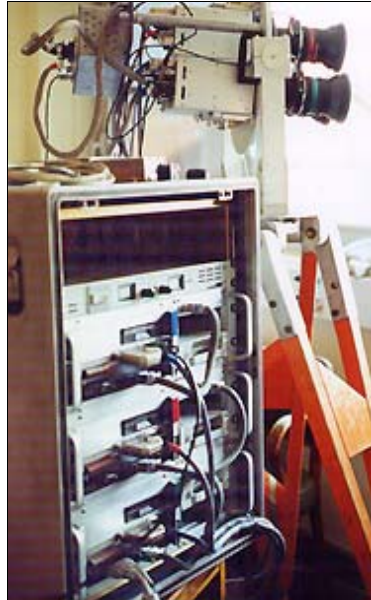
figure B.3.8 : les trois caméras (en arrière-plan) et leur électronique d'acquisition
