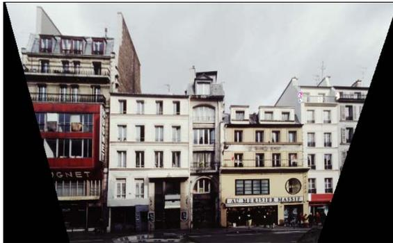
*figure B.1.10 : redressement à l'aide des deux points de fuite principaux*
