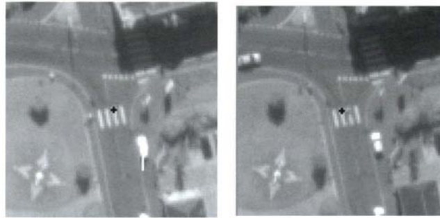
figure B.2.6 : exemple de source d'erreur : zone texturée
