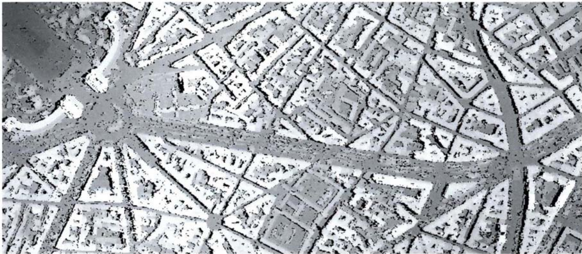
fig. B.2.3-b : disparités après corrélation (taille de la fenêtre de corrélation : 7 \times 7 ), les élévations sont exprimées dans le référentiel de l'image de gauche, on peut voir en noir les pixels non corrélés qui sont surtout des occlusions axiales. Certaines rues orthogonales à la direction de vol ne sont pas bien corrélées, on se trouve ici dans un cas où les images gauches et droites sont sources d'occlusions de part et d'autre de la rue et donc sources de confusions.
