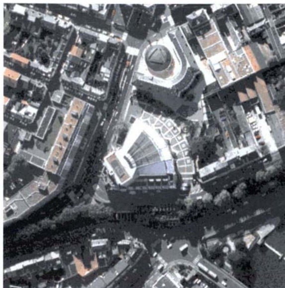
figure B.3.4b : le même extrait après correction du voile atmosphérique (gamma : 0,6).
