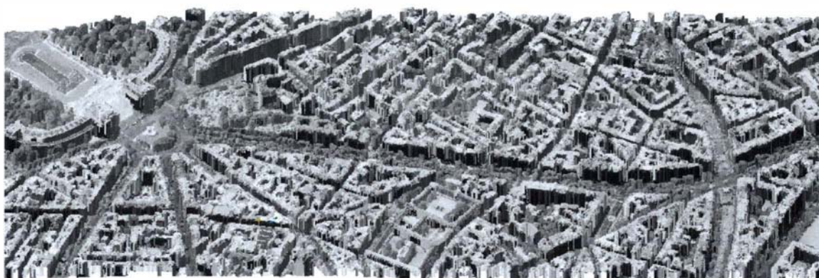
figure B.2.3-e : vue axonométrique réalisée à partir du MNE et de l'ortho-image.
