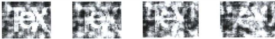
figure B.1.5 : résistance au découpage; marques extraites sur des images de taille 1000, 800, 600 et 400
