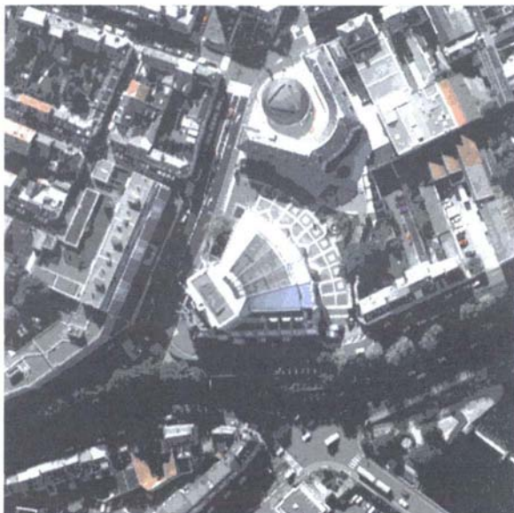
figure B.3.4a : extrait d'une image acquise sur Le Mans (pixel-sol de 40 cm) avant correction du voile atmosphérique (gamma : 0,7).
