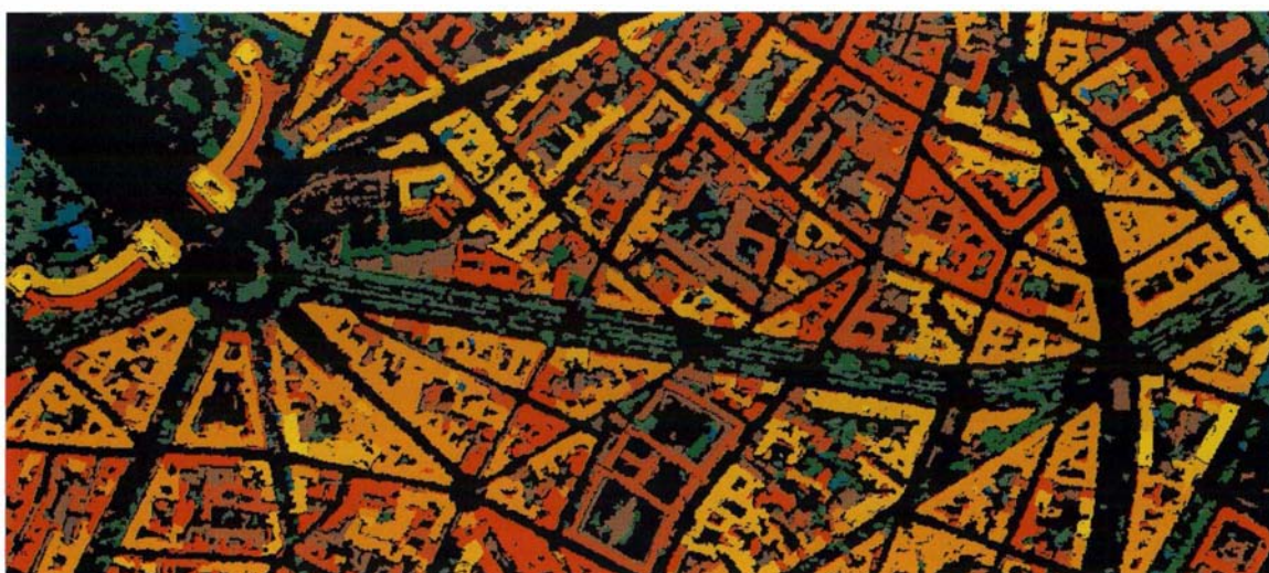
fig B.2.3-f : zones de sursol classées suivant leur thème (bâti : rouge, végétation : vert) et leur hauteur (du rouge sombre au jaune, du vert sombre au bleu-vert suivant les élévations croissantes). La classification du palais de Chaillot en bâti a entraîné la classification des arbres adjacents et de même altitude en "bâti", une classification par croissance de région aurait évité cela, en revanche, les résultats se seraient dégradés au niveau des toits des pâtés de maisons.
