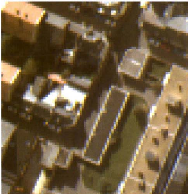
figure B.3.7a : extrait d'une image du Mans avant suréchantillonnage (pixel-sol équivalent à 80 cm)
