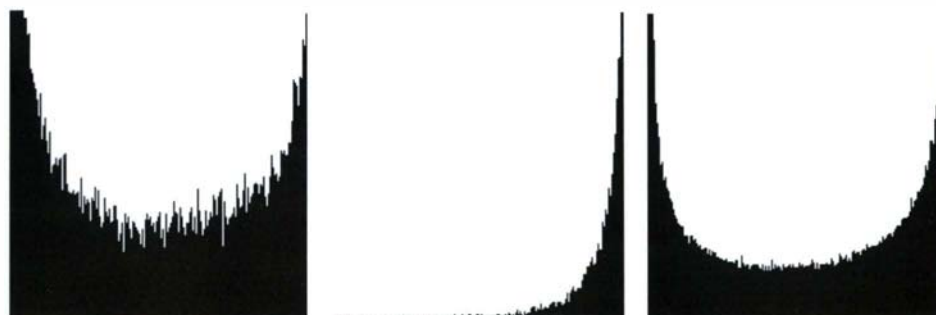
figure B.4.5 : nouveaux histogrammes calculés sur des valeurs réévaluées de l'entropie en fonction d'un histogramme calculé sur quelques millions de fenêtres aléatoires. On y voit apparaître les deux classes recherchées; un exemple de sélection des pixels de ces deux classes est donné en figure B.4.6a et B.4.6b. Les histogrammes sont volontairement tronqués au niveau des valeurs maximales pour une question de visibilité
