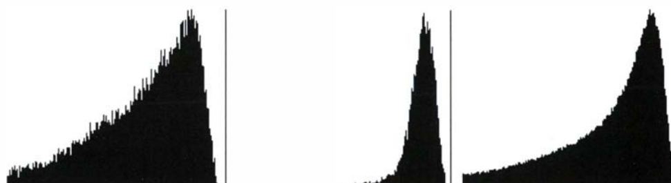
figure B.4.4 : histogrammes de l'indicateur entropique sur les images de la figure B.4.1 et sur l'image de la figure B.4.3. On n'y voit pas apparaître les deux classes recherchées, néanmoins la sélection des pixels de l'image correspondant aux entropies basses fait apparaître les zones structurées.
