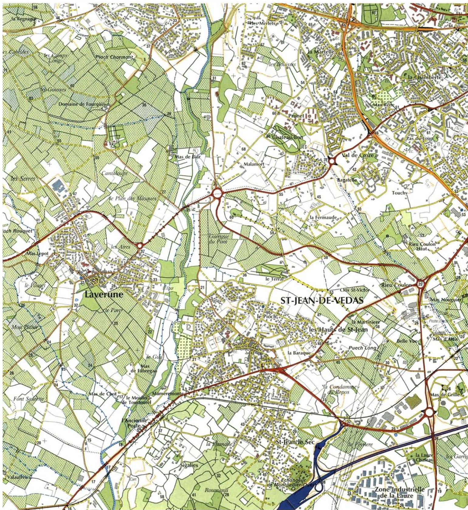
figure C.6.1 : à partir des données de la BDTopo, les écritures (lieux-dits, désignations, points-cotés) sont placés automatiquement sur une carte au 1:25 000, avec 90% d'entre elles placées de manière satisfaisante
