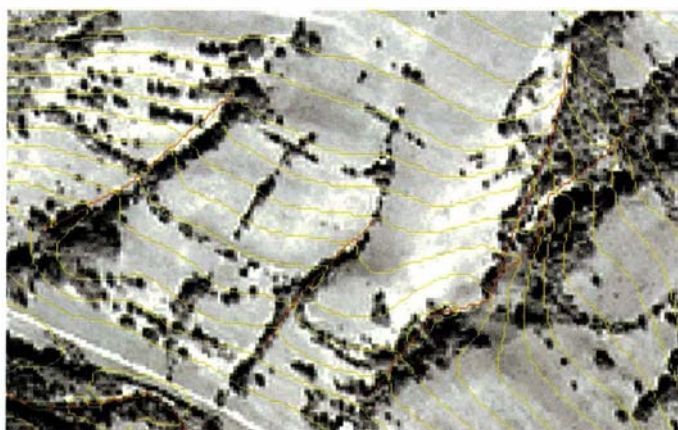
figure C.2.3 : lissage par la grille élastique avec lignes de rupture (saisies manuellement).
