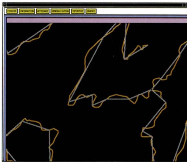
figure C.8.1 : visualisation des données routières de la BD Carto (en couleur) et des données filtrées (en blanc) par l'algorithme de WALL et DANIELSSON avec ou sans symbolisation
