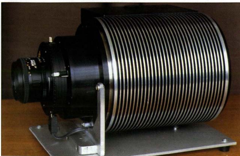
Prototype de caméra numérique matricielle (4000 x 4000 pixels) destinée à la prise de vues aériennes
