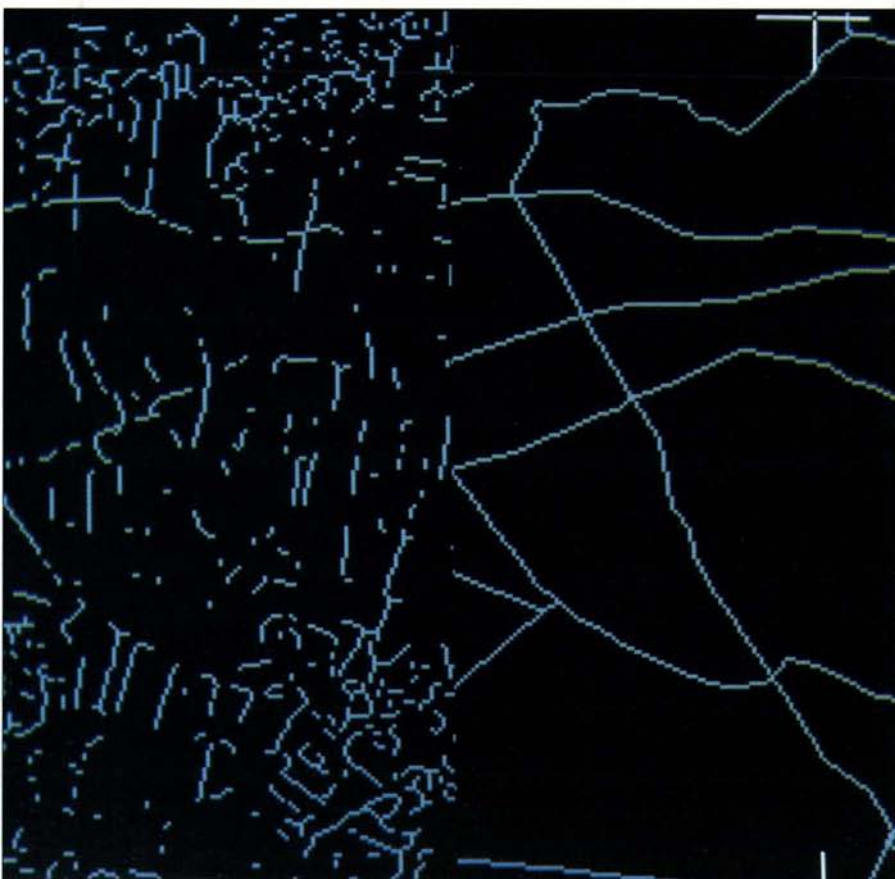
Résultat de l'extraction automatique de segments sur un extrait de l'image A gauche : Traitement de morphologie mathématique en niveaux de gris, puis seuillage par hystérésis. A droite : Réseau routier contenu dans la BD Carto (base de données IGN) sur le même extrait.
