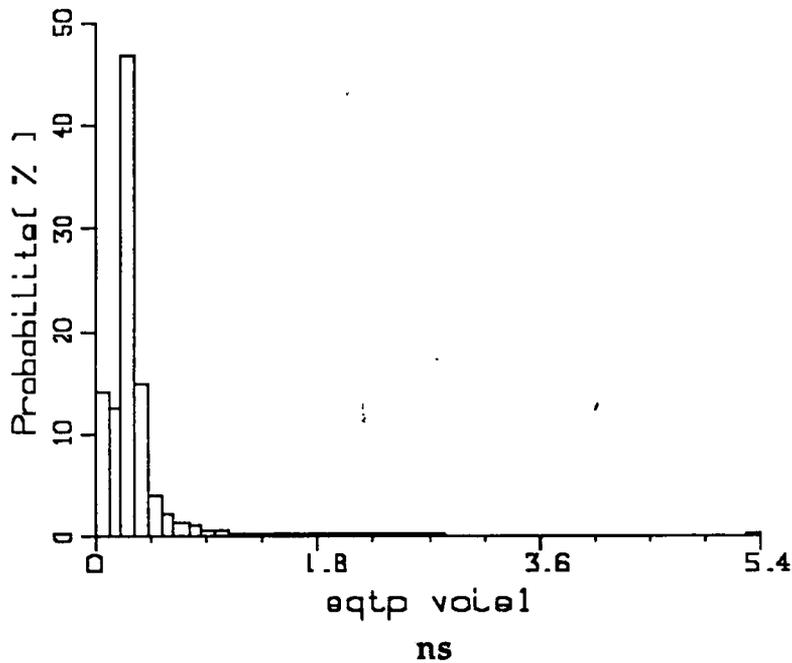
Figure 40: Distribution de l'erreur quadratique résiduelle sur le T.P.G en ns (eqtp). Antenne basse.
