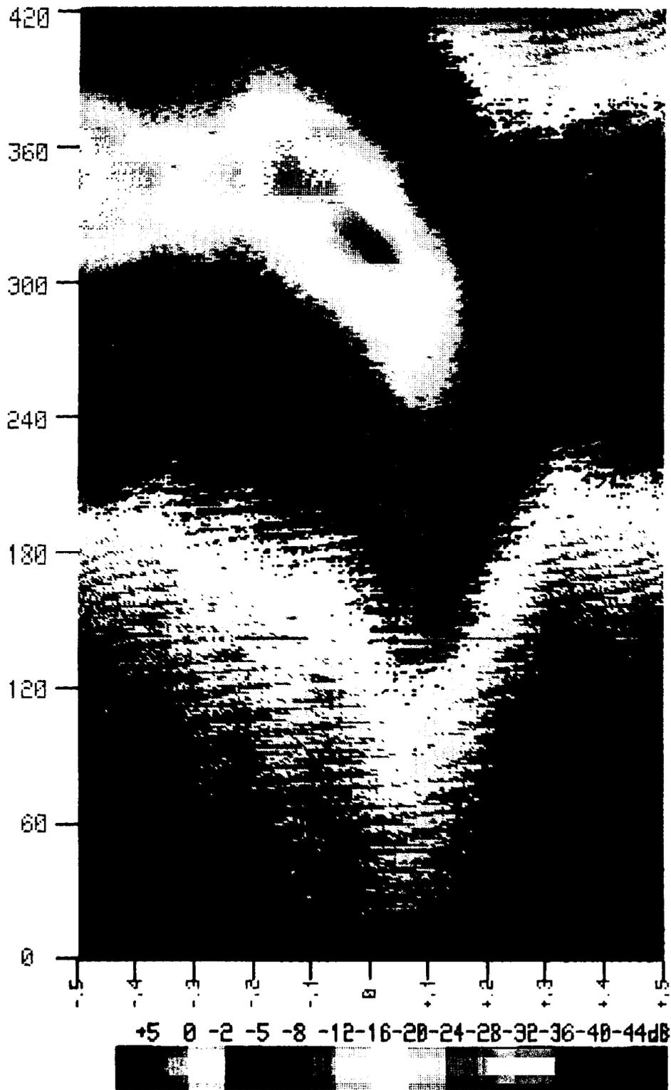
Figure 1: Variations en fréquence et en temps des affaiblissements provoqués par le phénomène de trajets multiples. Ces données, proviennent de la campagne de mesures PACEM 3 (1986). La fréquence, à partir de 10,7 GHz, est indiquée en abscisses par pas de 100 MHz et le temps est indiqué en ordonnées en nombre de fonctions de transfert (65 ms pour une fonction de transfert). Le code de couleur rend compte de la profondeur de l'affaiblissement.
