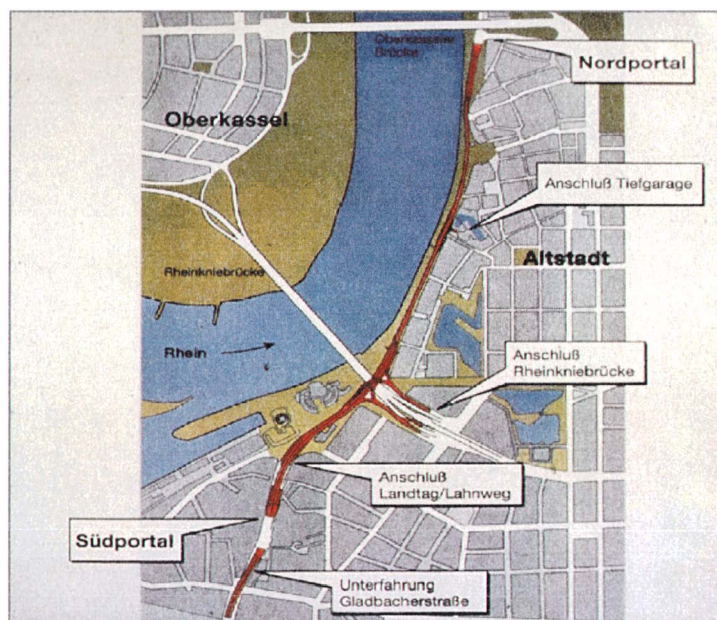
Tracé du tunnel avec ses points d'accès/sortie
