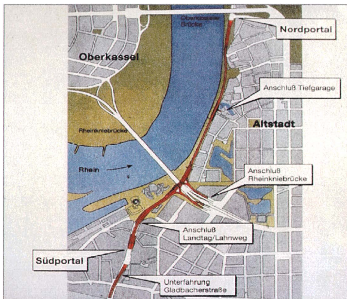
Tracé du tunnel avec ses points d'accès/sortie
