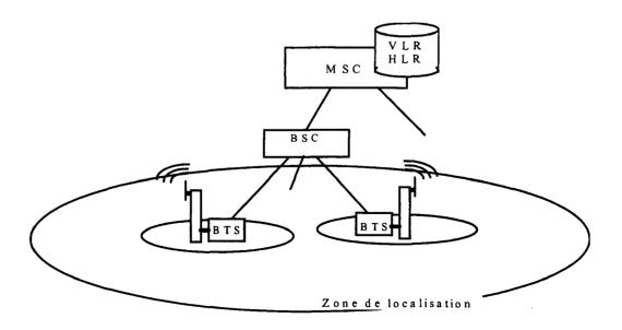
Le mode de fonctionnement des réseaux GSM (Global System for Mobile communications) impose à l'opérateur de pouvoir situer géographiquement un radiotéléphone afin de router tout appel entrant en direction de ce mobile. Des informations concernant l'abonné sont donc intégrées dans une base centralisée, mais également dans une base locale VLR attachée au MSC (Mobile service switching center) le plus proche du téléphone mobile.
