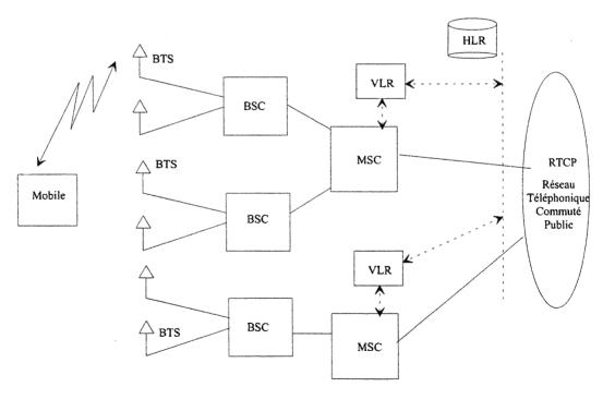
La station de base (BTS) comprend une ou plusieurs antennes (en forme de perche ou de panneau), un support et le matériel radio. Sa zone de couverture (cellule) correspond à la zone géographique pour laquelle le service de téléphonie mobile est assuré par un même relais.
