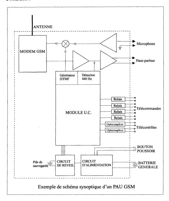
Afin de pallier aux insuffisances éventuelles des réseaux GSM (encombrement, saturation, propagation), des solutions techniques sont avancées par certains constructeurs et notamment ASCOM qui propose un PAU GSM « dual band » :
