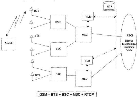
Une station de base peut supporter jusqu'à 84 conversations simultanées (12 fréquences X 7 appels).
