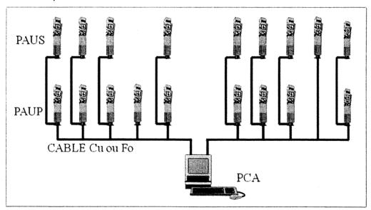
Le RAU de type B s'appuie sur le réseau téléphonique commuté (RTC) pour relier individuellement ses PAU au PCA. Ce type de RAU (support de transmission : 2 fils du RTCP) utilise le système, dénommé SIGTEL 3000, qui a été agréé par France Télécom en 1993. L'identification des postes s'effectue par signaux multi-fréquences Q23 CCITT et la capacité d'identification est égale à 99 PAU par poste de surveillance (PCA).
