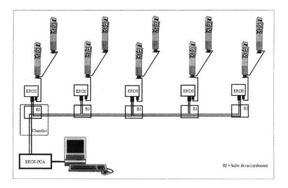
Utilisant une technique de transmission numérique, la mise en service des PAU est simplifiée : aucun réglage n'est à effectuer sur les interfaces. Le paramétrage se fait directement sur le poste par l'intermédiaire d'une console portable.
