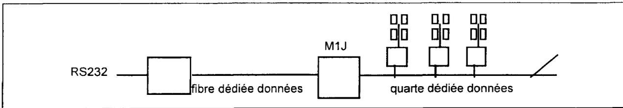
Les recueils de données et les PMV sont en bus sur une quarte cuivre. Les données sont transmises sur une fibre dédiée. L'ensemble est acheminé par une liaison électro-optique point à point entre le PC de Septèmes et M1J, de marque Connectinfo.
