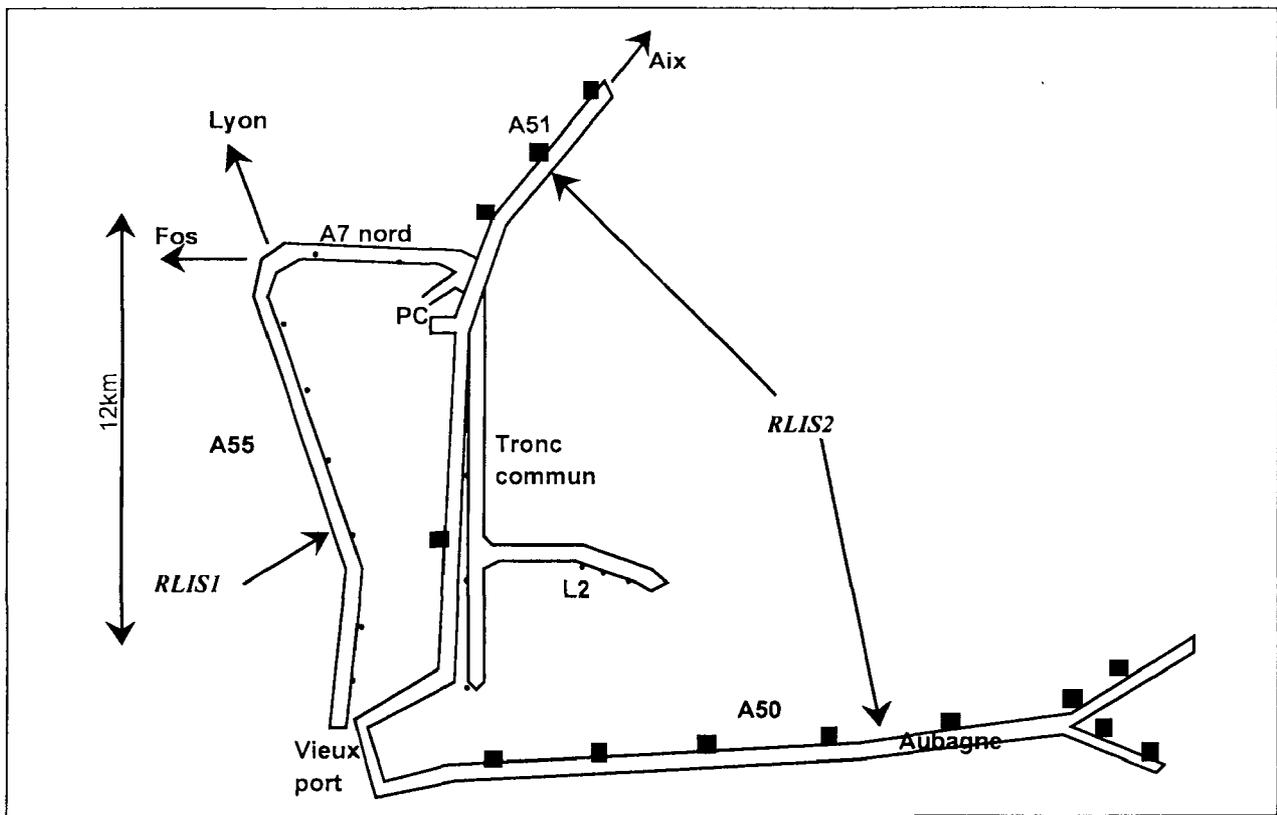
Le Réseau RLIS2 suit les mêmes principes : une boucle à plat unique pour A50 et A51. Plus tard, les boucles des RLIS pourront être transformées en anneau, introduisant alors une double sécurité (la sécurité actuelle au niveau de chaque site et la sécurité par double cheminement possible).
