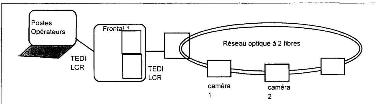
Le signal est régénéré à chaque site, avec une sécurisation : une panne sur l'interface électro-optique déclenche soit un passage sur la voie de secours, soit un by-pass à l'aide d'un relais optique passif assurant la continuité amont aval.
