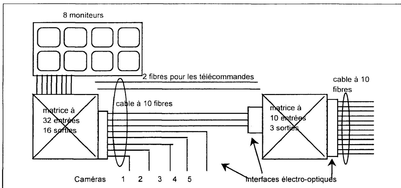
Ce système est en cours de modernisation. La matrice du PC a été remplacée par une matrice de grande capacité (128 entrées et 64 sorties). Les matrices déportées seront remplacées par des multiplexeurs permettant de transmettre jusqu'à 16 images vidéo sur la même fibre. Ce nouveau système permettra de disposer simultanément de toutes les images au PC, alors que le système actuel de matrices en cascade ne permet pas toutes les possibilités d'affichage.
