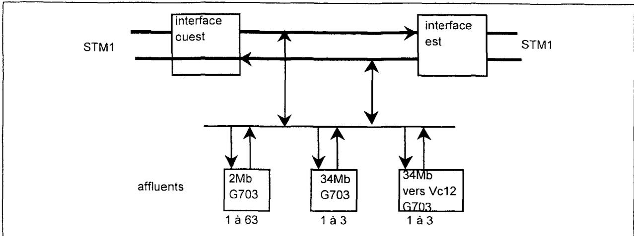
Une interface 2Mbit/s est connectée à l'un des VC12 de l'équipement SDH à 155Mbit/s. Le réseau doit satisfaire les recommandations correspondantes du CCITT. En particulier, il peut être géré à partir de n'importe quel point d'entrée. Le système de multiplexage permet, dans chaque site, d'insérer / extraire jusqu'à 30 accès voix et /ou données à 64ko dans une trame à 2Mbit/s.
