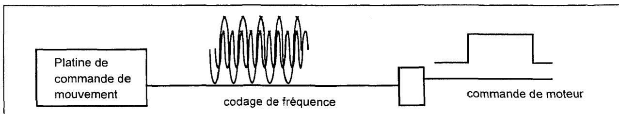
Chaque commande est un codage de fréquence reconnu par le décodeur de la caméra.
