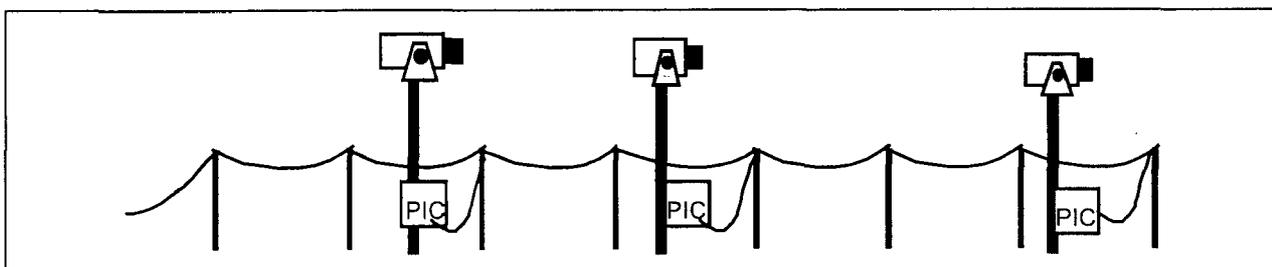
Le câble est ouvert à chaque caméra. Le faisceau de fibres est éclaté à l'intérieur de l'interface en boîtier semi-étanche pour dériver la fibre vidéo (une fibre par caméra) et la fibre du bus de données de télécommande. Les fibres non utilisées sont maintenues en continuité :
