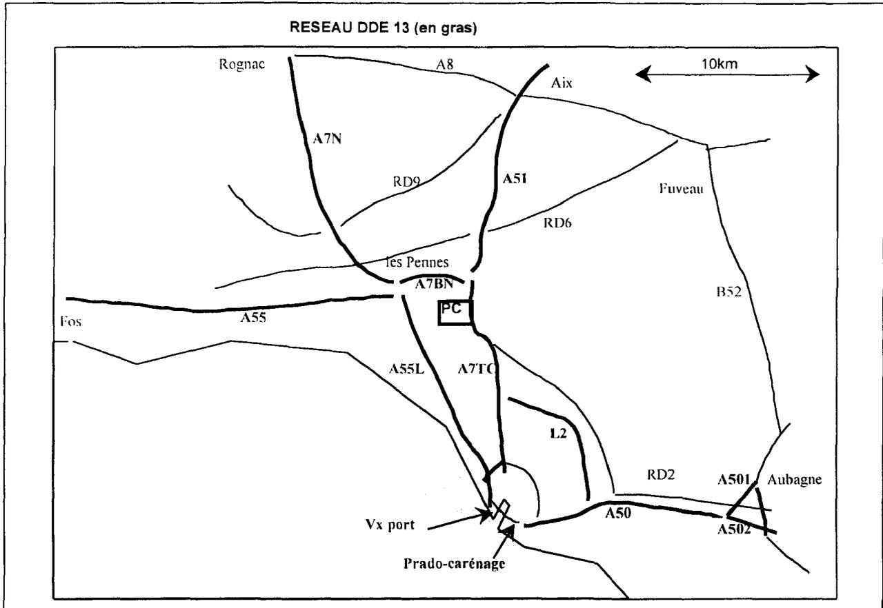
Les secteurs les plus chargés sont A7TC et A50, avec chacun 140 000 véhicules/jour, et un débit maximal de 6500 véhicules sur 3 voies à l'heure de pointe. Le secteur A55L est fortement sollicité dans la partie sud. La rocade L2 n'est opérationnelle que dans sa partie nord. Le raccordement au secteur A50 devrait être terminé à l'an 2000.
