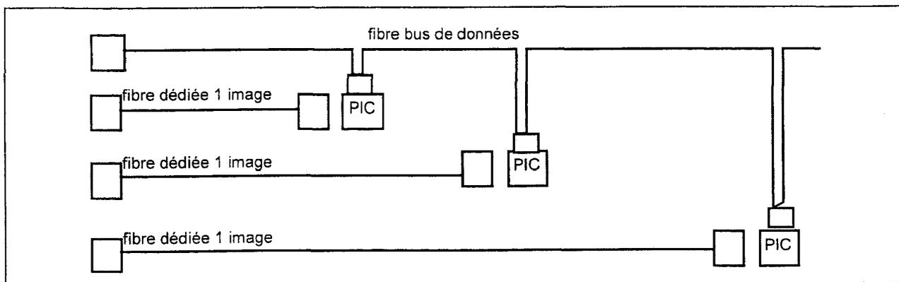
Les images vidéo sont acheminées à raison d'une image par fibre par une interface de marque Radiall. Les commandes de caméra sont transmises sur un double bus optique de marque Connectinfo.
