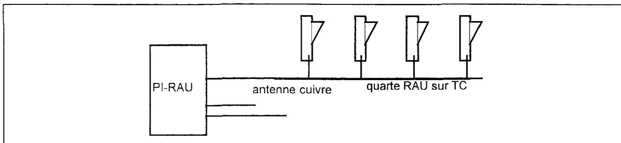
Le protocole entre un PAU et le PI-RAU est le protocole n°1 du Cahier des Charges du SETRA, qui permet, sur une voie phonique (par découpage d'une bande de fréquence de 2900 Hz environ) de connaître le n° du poste appelant et quelques autres états du PAU et, dans l'autre sens, d'appeler un PAU et d'assurer quelques autres télécommandes tout ou rien ou tests automatiques. Le protocole permet aussi d'assurer la connexion phonique.
