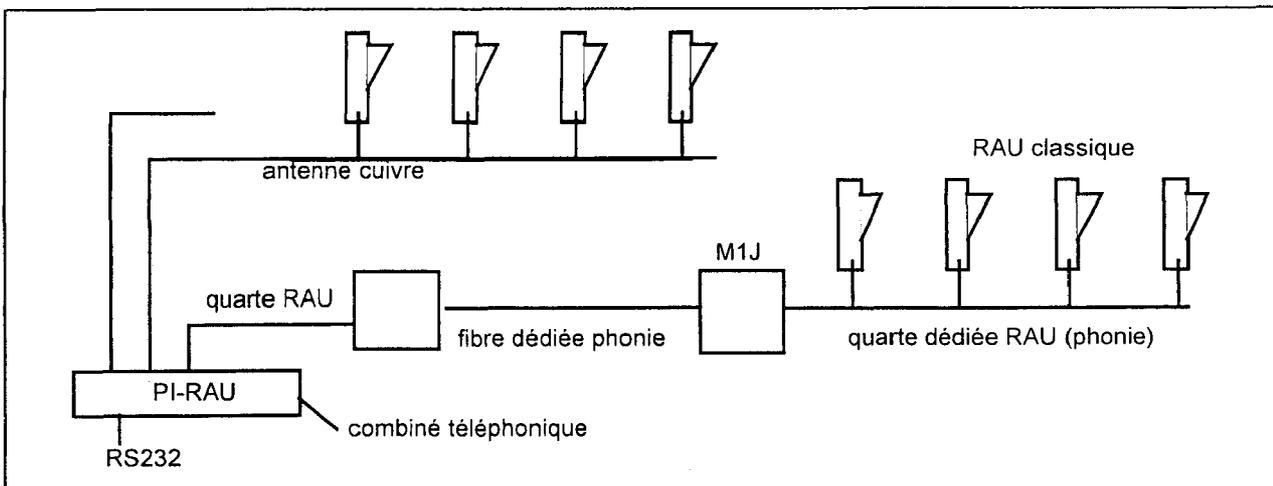
Le RAU lointain est sur une antenne cuivre classique. Le signal phonique est transmis sur une fibre dédiée et est restitué au Pilote Informatique de RAU du PC sur une quarte cuivre comme une antenne cuivre classique. Les signaux BF et la phonie RAU sont acheminés par
