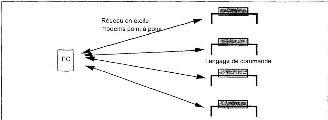
Les transmissions se font en RS232 sur modem 200Bds en point à point full duplex, soit une paire téléphonique par PMV. La commande/contrôle se fait à l'aide d'un langage de commande élémentaire, avec protocole intégré.
