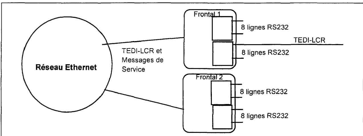
Le rôle des frontaux de communication est de soulager les Processus de traitement de la gestion des lignes de transmission. Ils reçoivent des processus les messages à transmettre, mettent ceux-ci en file d'attente ou en forçage immédiat de la scrutation cyclique des stations sur la ligne correspondant à l'adresse TEDI, organisent le cadencement des questions et des
