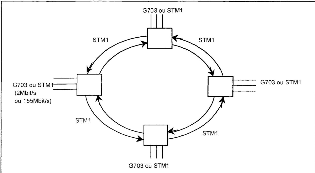
Le réseau accepte différentes topologies : point à point, multipoint ou anneau. Un réseau point à point doit pouvoir évoluer vers un réseau multipoint et vice-versa et, un réseau multipoint doit pouvoir évoluer vers un réseau en anneau et vice-versa.
