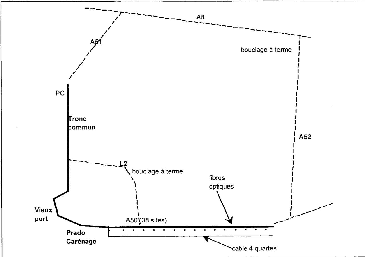
Le réseau proprement dit commence à la sortie du tunnel Prado-Carénage, jusqu'à Aubagne, à la limite de l'autoroute concédée à Escota. Le câble cuivre existant sur ce secteur a été conservé pour maintenir le RAU en l'état.
