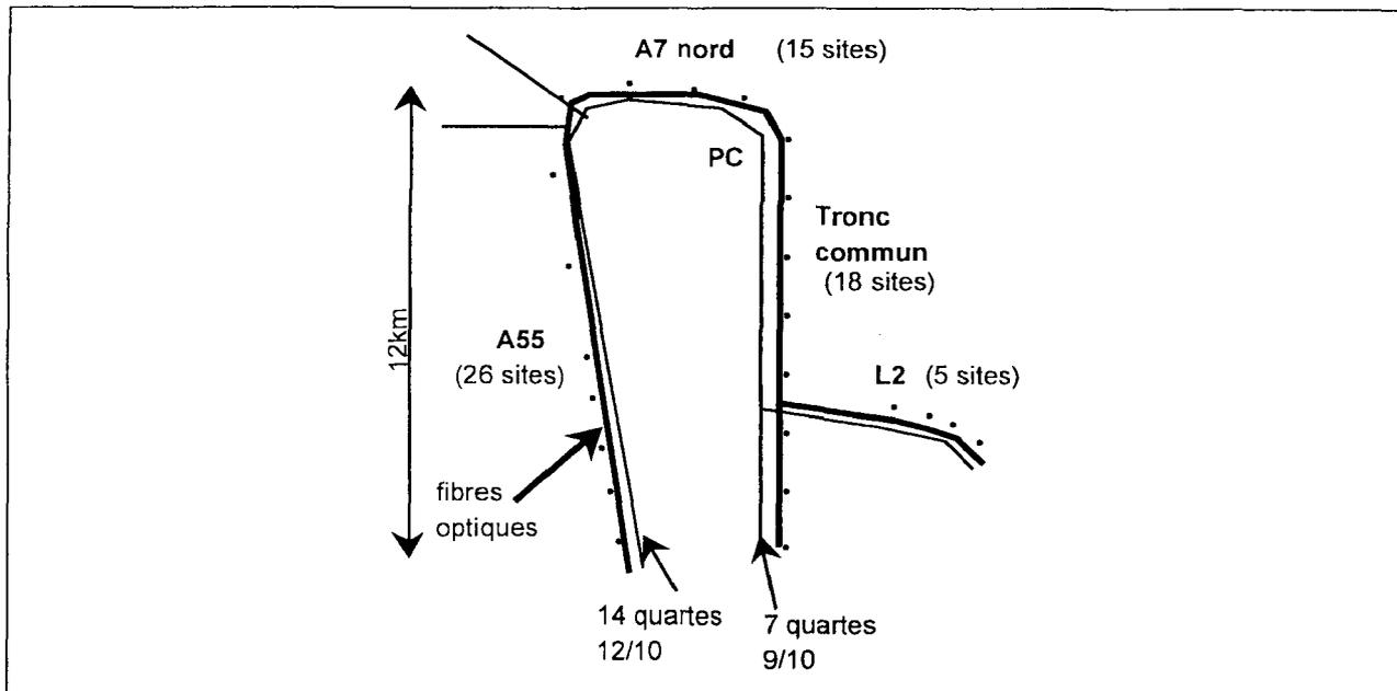
Un câble à 10 fibres optiques (en jonc) multimode chemine sur les 10 km. Il passe en coupure au niveau de chaque caméra (10 caméras), dans un tiroir de brassage placé dans une des baies à l'intérieur de l'abri technique.
