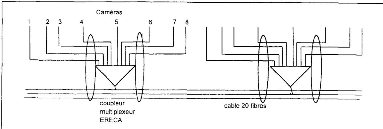
Les signaux analogiques sont injectés en analogique dans les coupleurs de marque ERECA, qui les numérisent (sans compression) et les acheminent optiquement jusqu'au PC ou elles sont restituées sous forme analogique.
