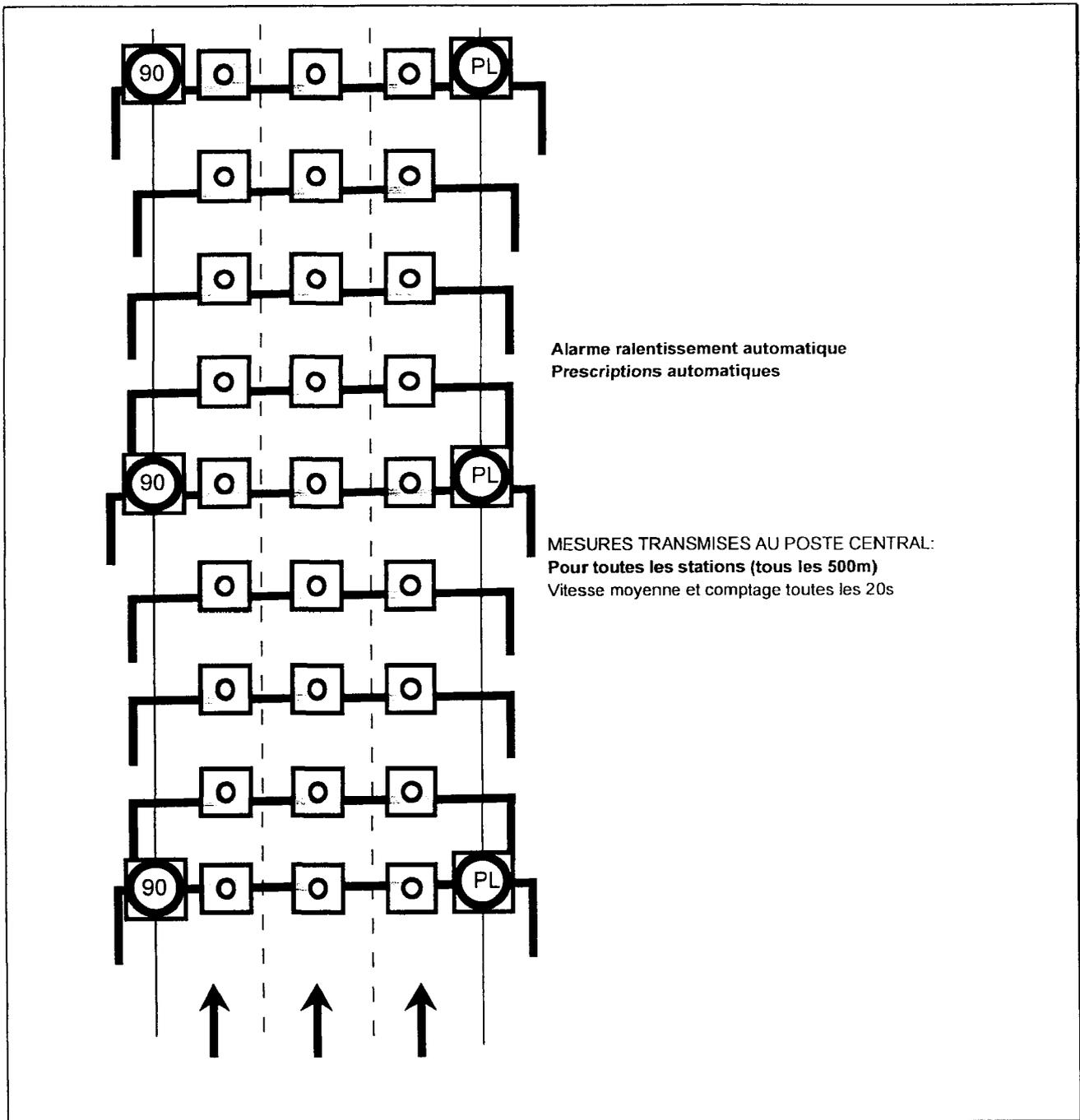
Le système central est indépendant du système 1976. Il suit les évolutions technologiques de l'époque : un simple ordinateur individuel SORD, (équivalent d'un Apple2, programmé en BASIC, 64 K de RAM, disque souple 5") assure à peu près les mêmes fonctions que le système 1976. L'ordinateur est interfacé avec une console couleur et avec le frontal de transmission.
