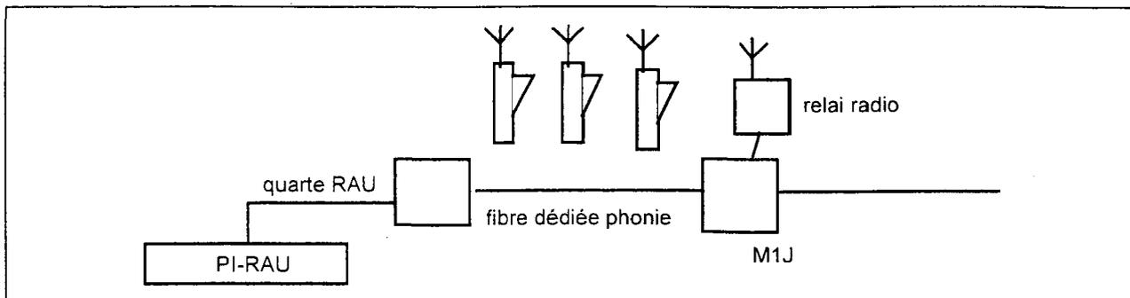
Le RAU entre le PC de Septèmes et M1J est constitué de bornes radio et de bornes classiques au-delà.
