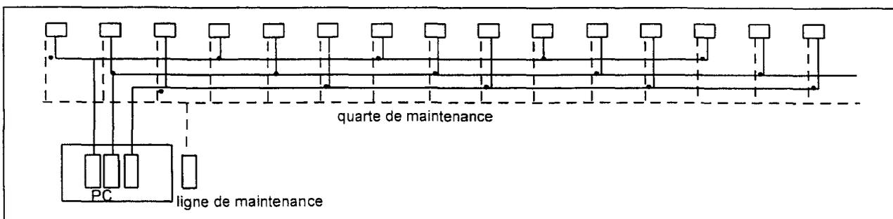
Un deuxième réseau, sur une quarte dédiée, dite quarte de maintenance, permet de se connecter sur le deuxième port série de chaque équipement. Les deux réseaux utilisent des modems multipoints TELSAT 1564 en bande de base à 9600 Bds, avec le protocole NFP99302-TEDI.
