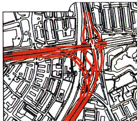
Détail de Julianaplein dans la variante C3 où le tracé A7 passe directement, en tunnel, de l'A28 vers le nord-ouest
