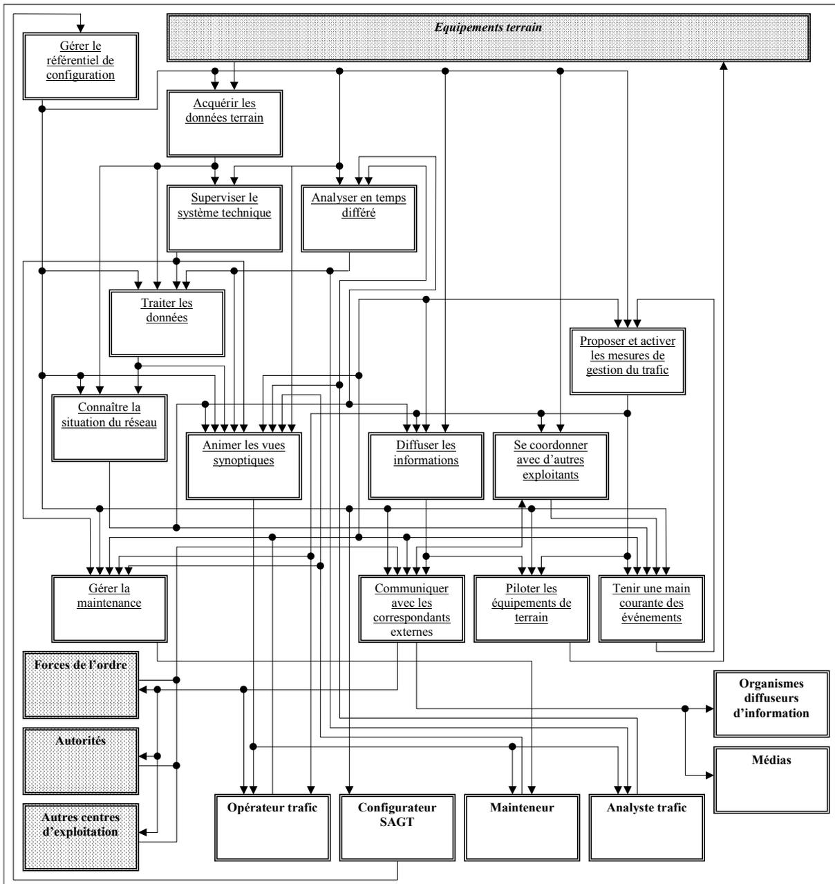
**Figure 3 : Schéma global des fonctions d'un SAGT**
