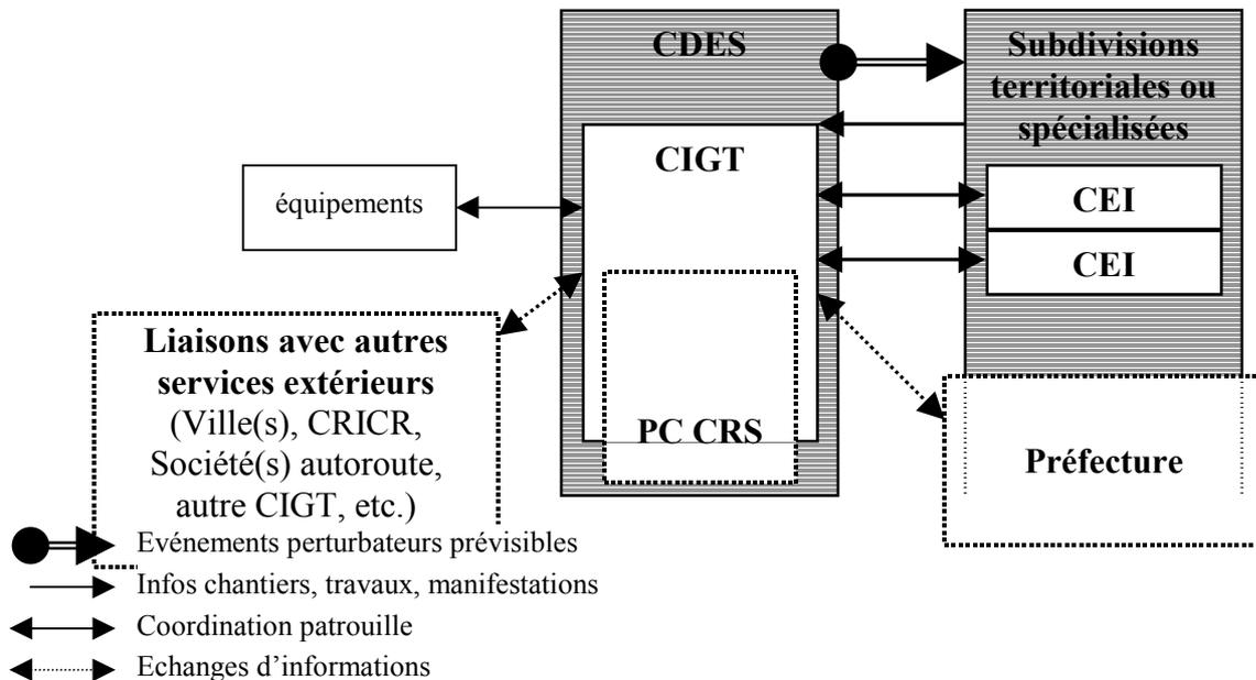
**La spécificité du projet Dor Breizh** est qu'il n'y a pas une exploitation commune et permanente avec un PC CRS. Il y a une relation (des échanges) avec un PC Forces de l'ordre uniquement en période de crise. Le SAGT devra être pilotable à 80% à domicile. Autrement, il apparaît aussi des échanges importants avec la Ville de Rennes.
