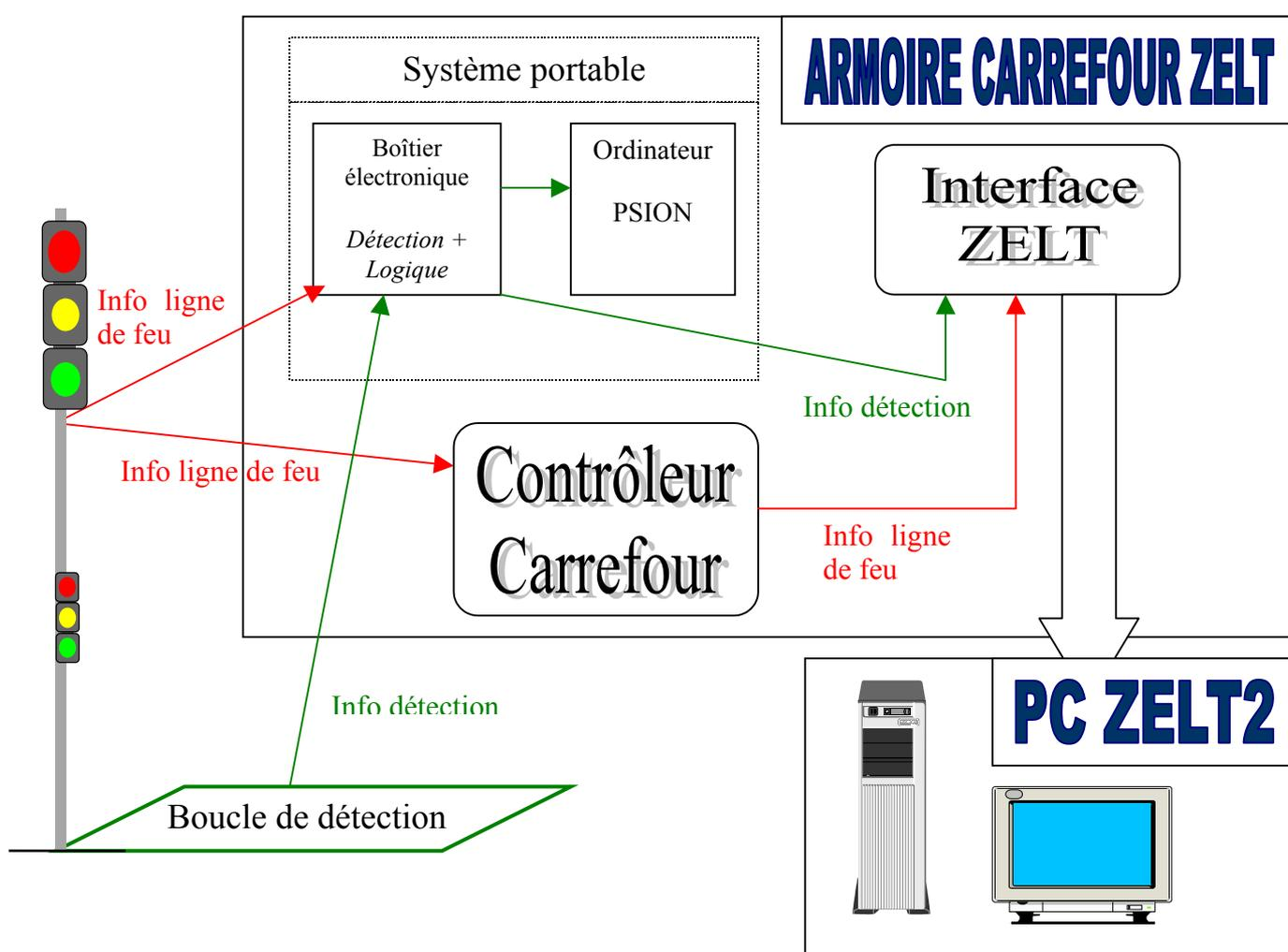
Le boîtier électronique du système portable est composé d'une carte détecteur qui analyse les perturbations électromagnétique de la boucle de détection. Ce boîtier transmet à l'interface ZELT l'information de détection de véhicules.
