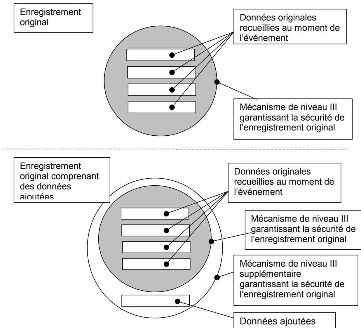
Figure 9.1 Concept d'ajout de données à un enregistrement
