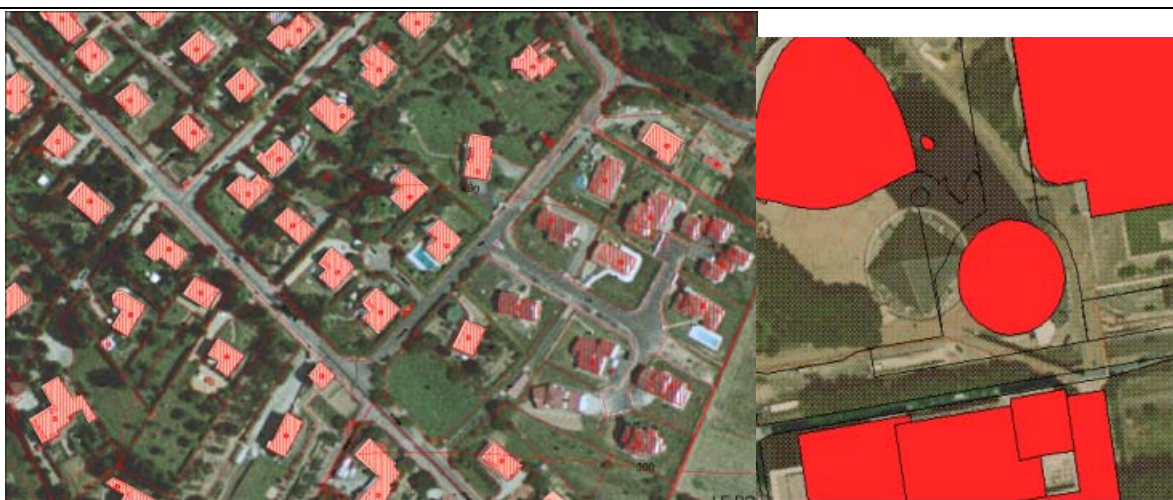
Exemple de superposition cadastre, BD TOPO®, BD ORTHO® en milieu rural à gauche (PCI) et urbain (Lyon, cadastre numérique) Excellente superposition au sol (remarquer l'ombre de la tour et son emprise cadastrale) et BD TOPO® moins à jour que le cadastre.
