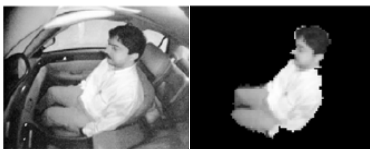
Figure 9. Image brute (gauche) et Image extraite (droit) du passager
