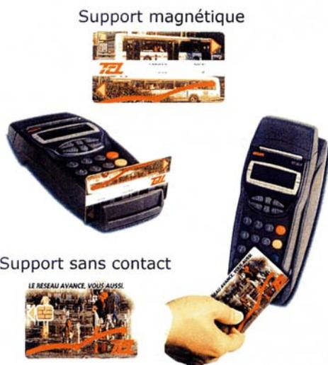
Le contrôle se fait via un portable de contrôle (terminal de paiement par carte bancaire adapté informatiquement au contrôle des titres).
