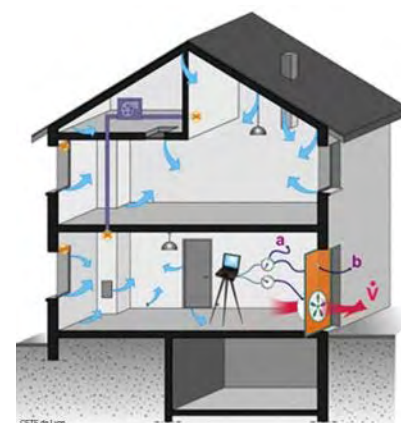
Figure 2 : Mesure du débit de fuite à l'aide d'une fausse porte, source : CETE de Lyon
