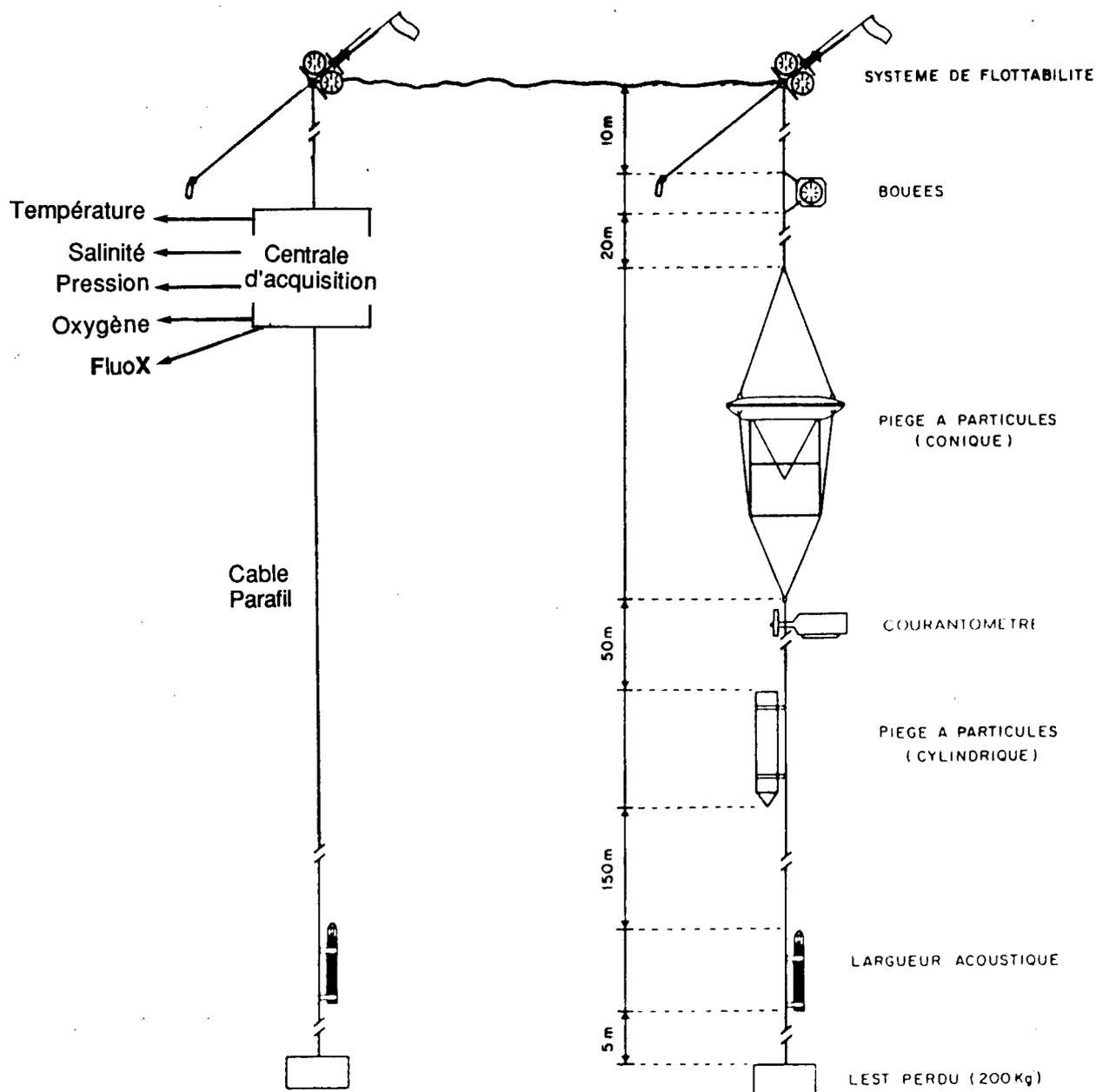
**Fig 9** Schéma de principe du mouillage double prévu pour Antarfix
