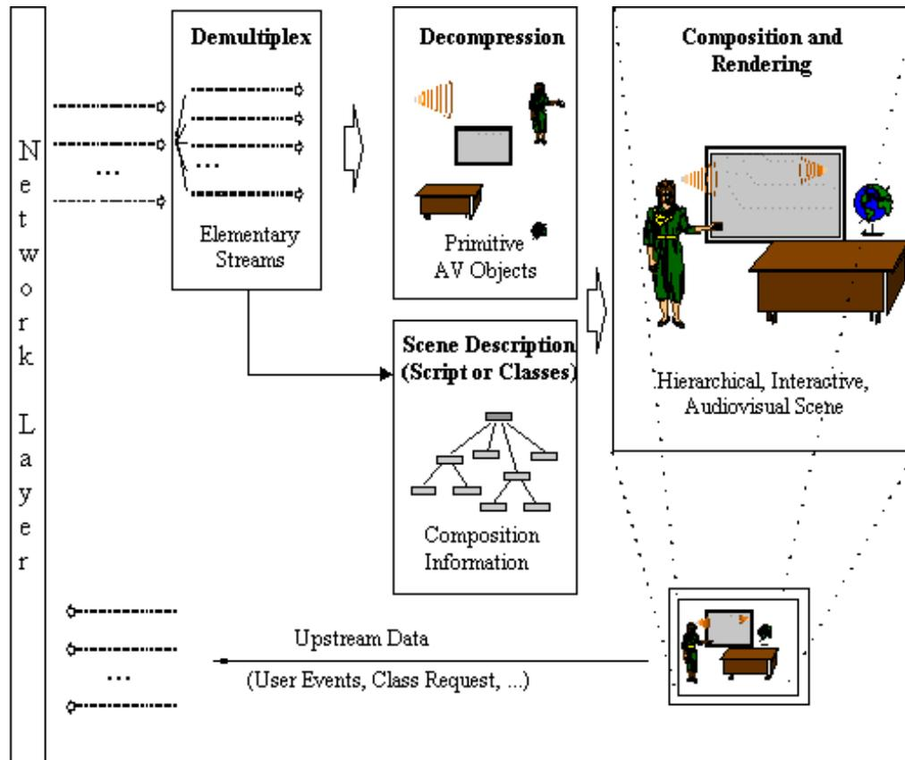
FIG. 11: Un système MPEG4 complet
