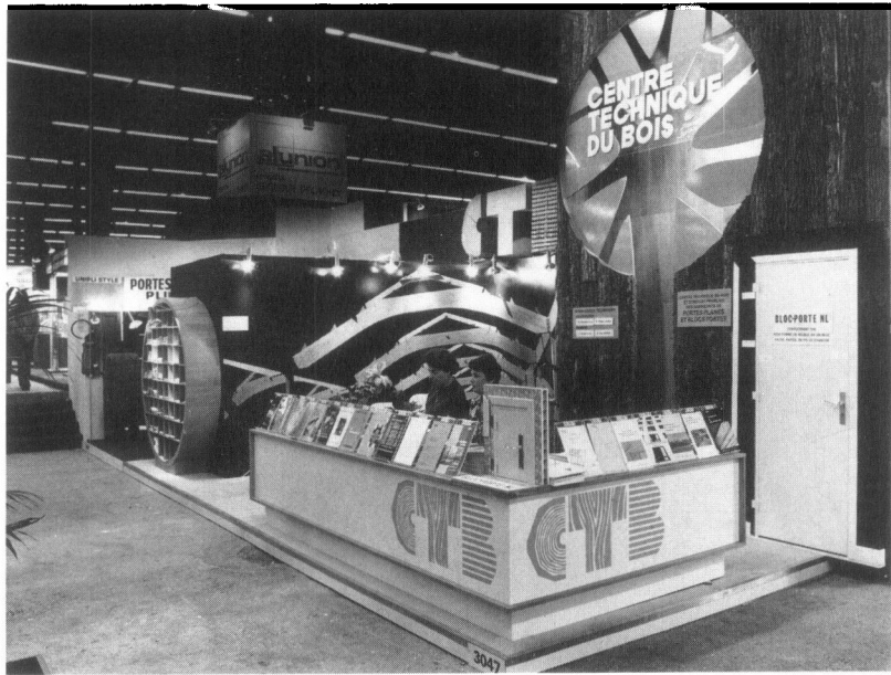
A la demande du Syndicat national des fabricants de portes et blocs-portes et en collaboration avec un groupe de travail désigné par ce syndicat, le C.T.B. a mis au point un bloc-porte de communication intégrable à la plupart des cloisons sèches. Ce bloc-porte baptisé N.L. est complètement fini, ferré et ajusté en usine. Il se pose comme un meuble, en fin de chantier, rapidement, réellement en un bloc, sans degondage du vantail. Le C.T.B. l'a présenté sur son stand à Bâtimat 77.
