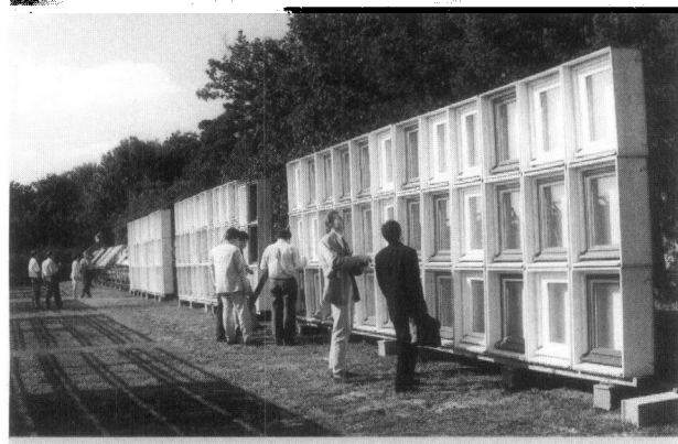
Vieillissement naturel sur petites menuiseries.
