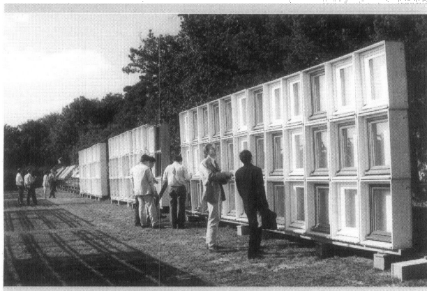
Vieillissement naturel sur petites menuiseries.
