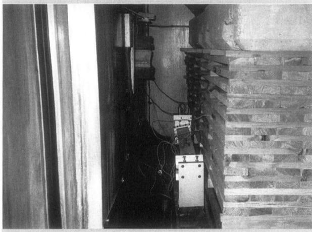
industrielles viables, il est nécessaire d'étudier de façon objective et mesurable l'influence du mode de séchage des petits bois sur leurs déformations. Les dimensions des sciages incriminés sont les suivantes : épaisseur 27 mm, largeur 85 mm, longueur 2 m.
