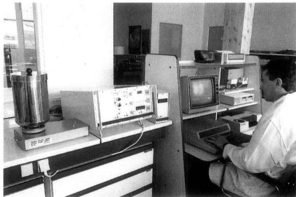
La calorimétrie différentielle à balayage pour la mesure de la température de transition vitreuse permet d'étudier le vieillissement des polymères.
