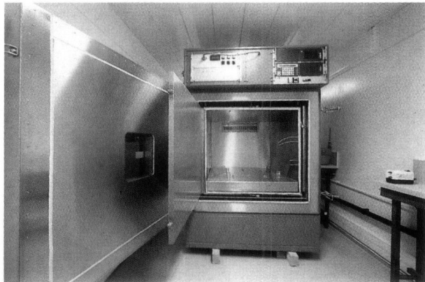
Chambre climatique pour l'analyse de substances chimiques dans l'air.
