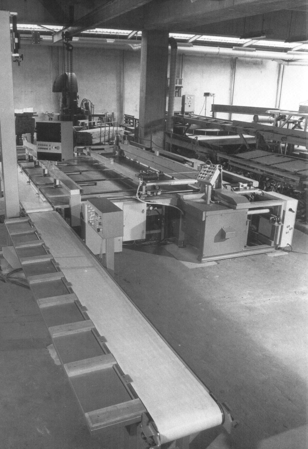
Vue partielle de la centrale de débit automatique des avivés. A gauche, la station de lecture par laquelle on acquiert les dimensions des avivés et la position des défauts marqués et, à droite au 1 er plan, la déli-gneuse. La tronçonneuse et le triage seront réalisés en 1985.
