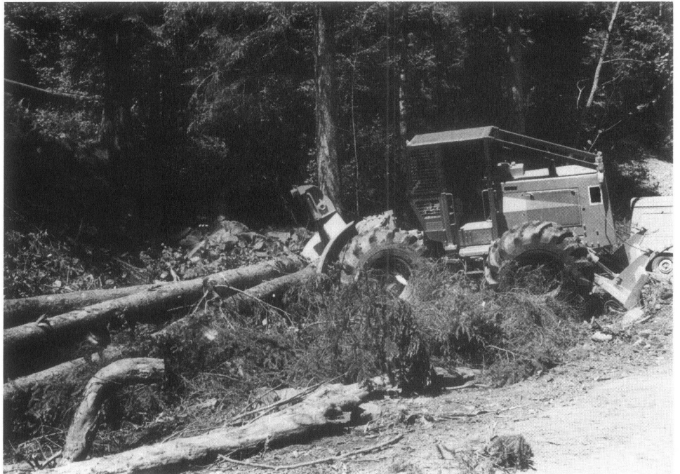
Tracteur à châssis articulé, équipé d'un treuil branché directement à la sortie d'un convertisseur de couple de la chaîne cinématique.
