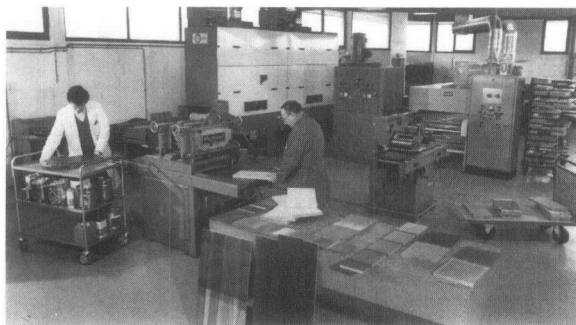
Laboratoire de finition du C.T.B. à Champs-sur-Marne : Ce laboratoire expérimental permet de réaliser les différentes opérations de mise en teinte, vernissage et laquage exécutées dans les industries de l'ameublement.
