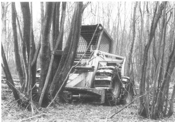
*Le découpage des perches de taillis en forêt est réalisé grâce à une découpeuse mobile, possédant sa propre grue de chargement. Ce type de matériel a permis de réduire de 20 % environ le coût de la mise en plaquettes. Les plaquettes sont projetées directement dans une semi-remorque.*
