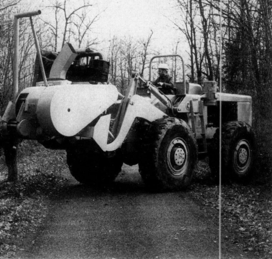
Ci-dessus : Maquette fonctionnelle de machine intégrée d'exploitation des taillis. Il s'agit d'une abatteuse-découpeuse pour bois de petites dimensions dont la mise au point se poursuit actuellement.
