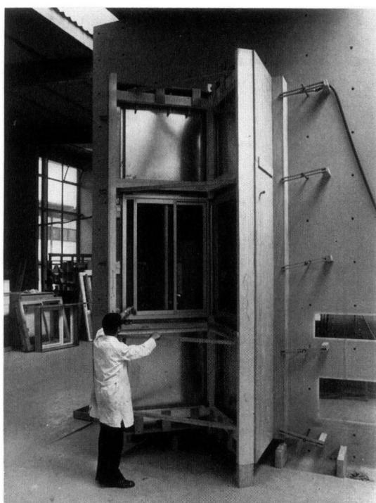
Mur d'essais à la Station expérimentale du C.T.B. à Champs-sur-Marne.
