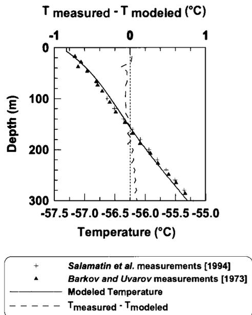
Figure f3. Température mesurée et modélisée dans le névé et le haut du forage de Vostok.
