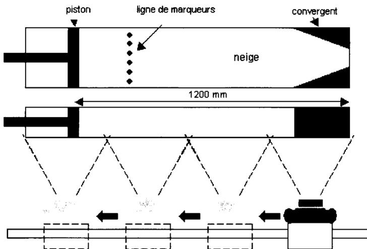
Figure i1. Schémas du dispositif en coupe horizontale (haut) et du dispositif de prise de vues.
