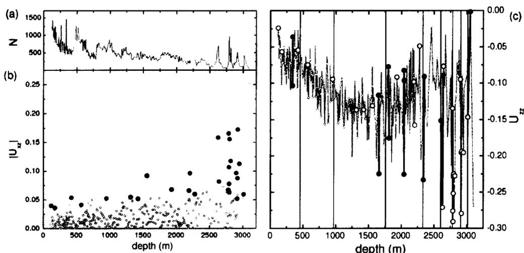
Figure f2. Déformation des couches de glace le long du carottage de Dôme Concordia, mesurée à partir de la déformation des grains. (b) Composante de cisaillement horizontale,  $U_{xz}$ . Certaines couches anormalement cisillées sont indiquées en points noirs. (c) composante de compression verticale,  $U_{zz}$ . Les hétérogénéités de déformation (variations brutales de l'amincissement) sont indiquées en noir.
