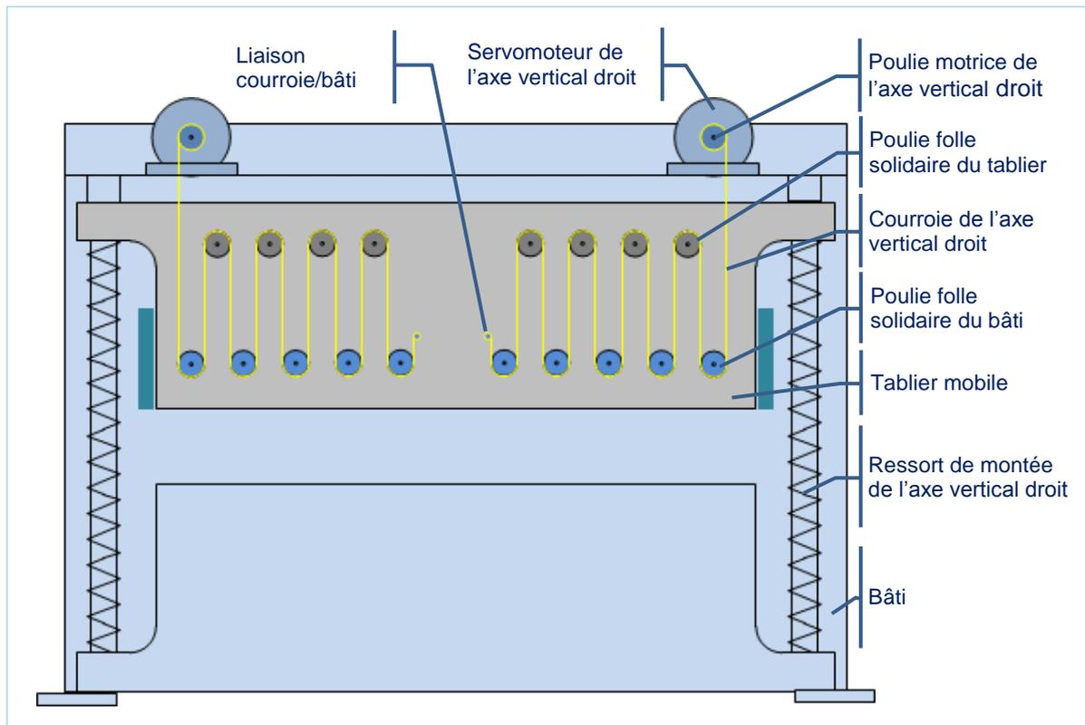
Figure 16 : Principe de l'entraînement par système poulies/courroies
