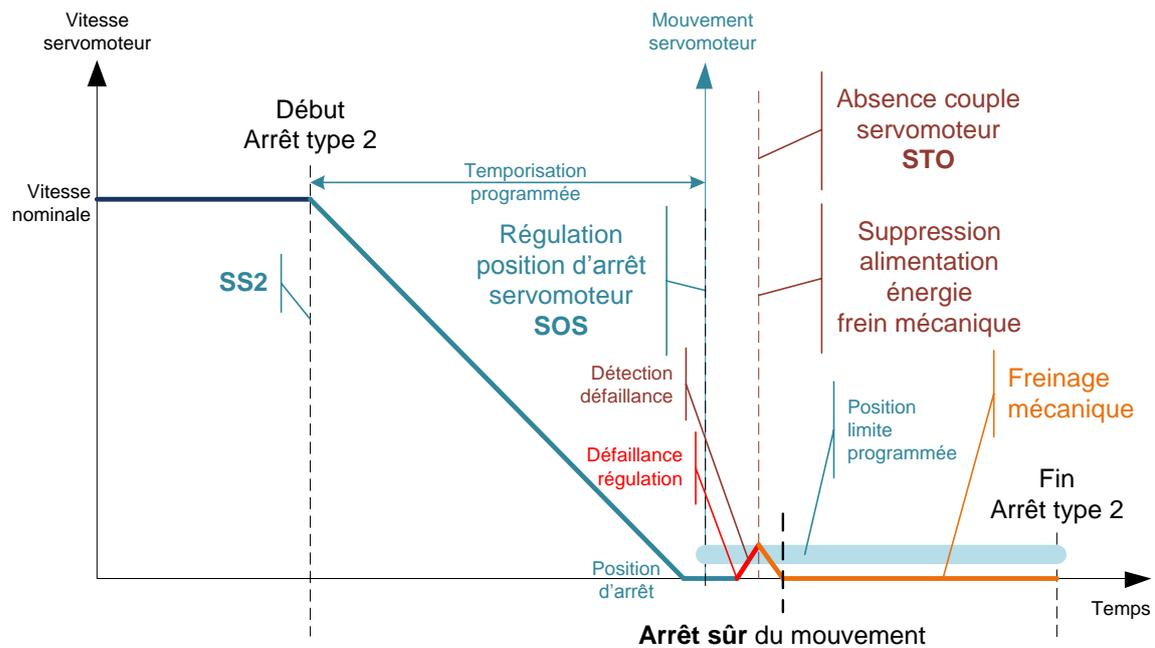
Figure 33 : Chronogramme d'une fonction d'arrêt sûr type 2 avec mise en œuvre d'une fonction SS2, c), et réaction en présence d'une défaillance de régulation du PDS/SR pendant la phase de maintien à l'arrêt
