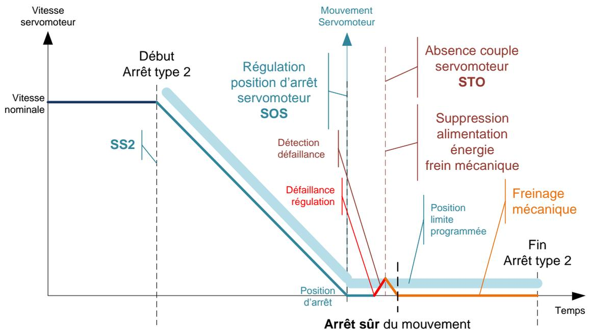
Figure 30 : Chronogramme d'une fonction d'arrêt sûr type 2 utilisant une fonction SS2, b), et réaction en présence d'une défaillance de régulation du PDS/SR pendant la phase de maintien à l'arrêt
