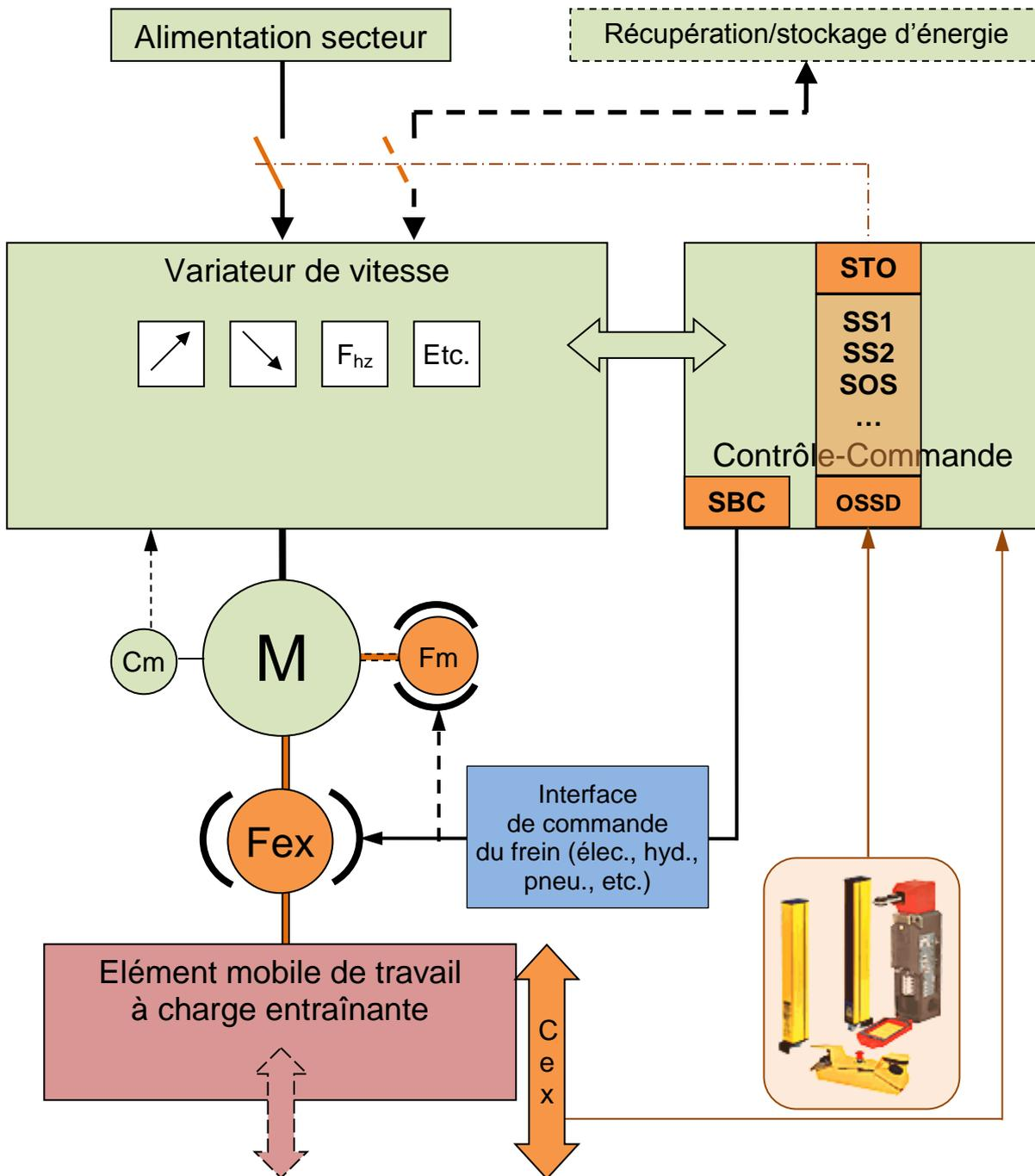
Figure 35 : Intégration d'un PDS/SR dans le circuit de commande d'une presse à servomoteur -
