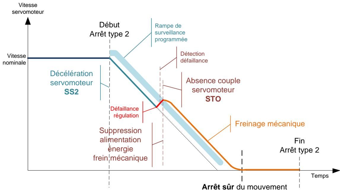
Figure 29 : Chronogramme d'une fonction d'arrêt sûr type 2 utilisant une fonction SS2, b) ; et réaction en présence d'une défaillance de régulation du PDS/SR pendant la phase de décélération
