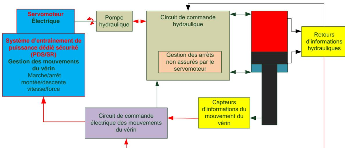
Figure 5 : Exemple schématique de presse hydraulique à servomoteur
