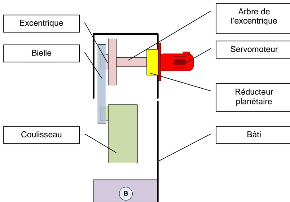
Figure 14 : Représentation schématique d'un entraînement avec réducteur planétaire
