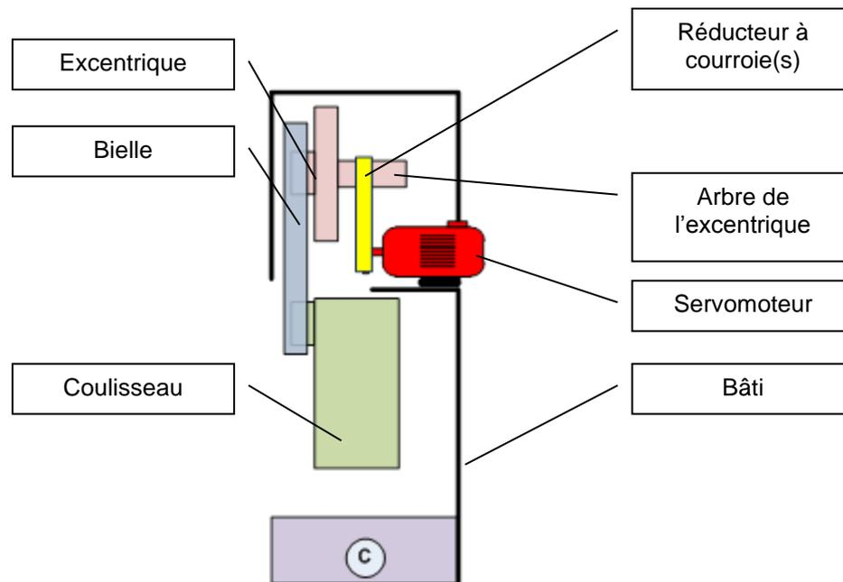
Figure 15 : Représentation schématique d'un entraînement à courroie(s)
