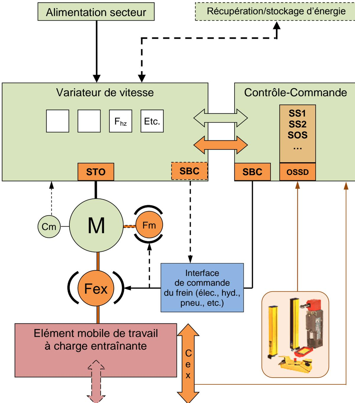
Figure 36 : Intégration d'un PDS/SR dans le circuit de commande d'une presse à servomoteur -
