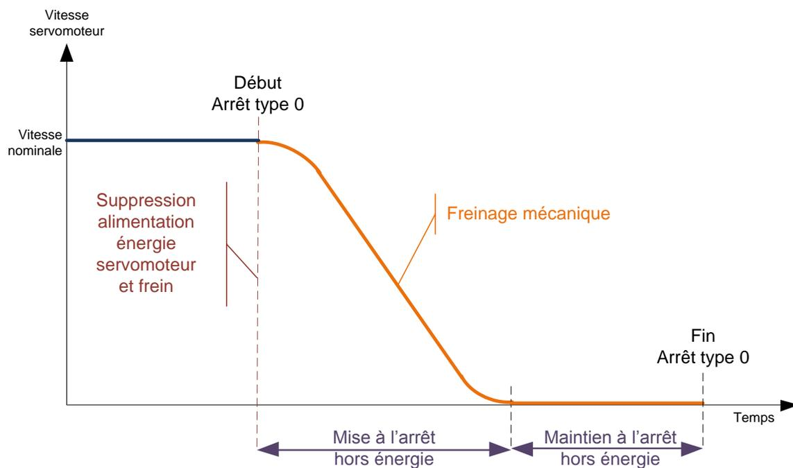
Figure 18 : Chronogramme de principe d'un **arrêt sûr type 0**
