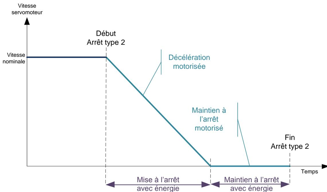
Figure 20 : Chronogramme de principe d'un arrêt sûr type 2
