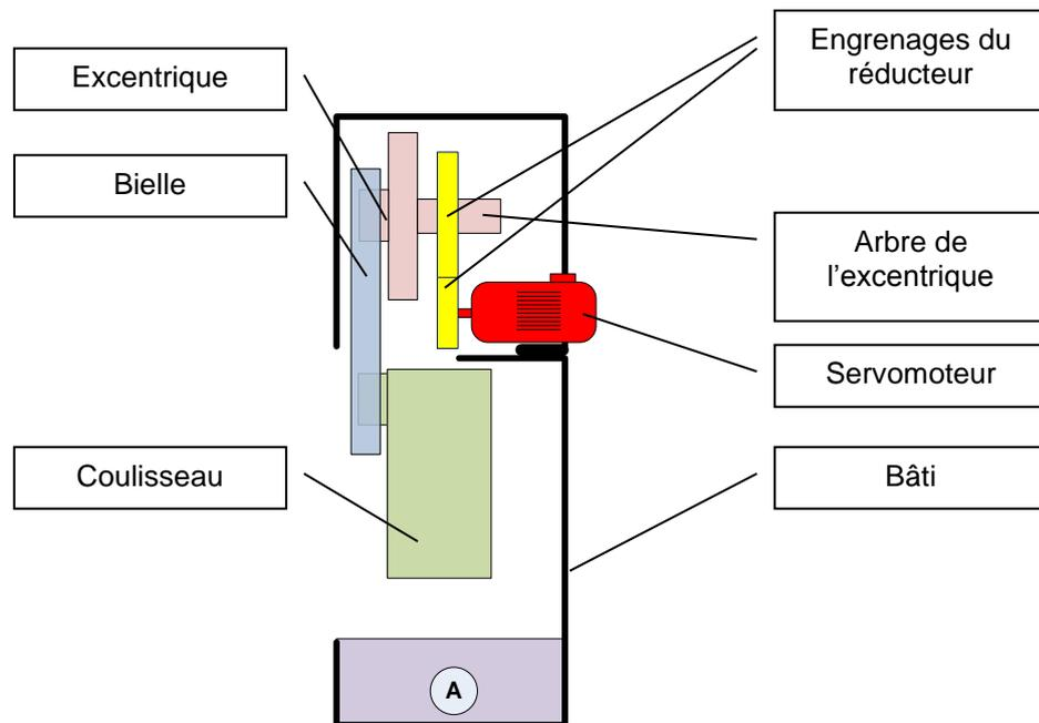
Figure 13 : Représentation schématique d'un entraînement avec réducteur déporté
