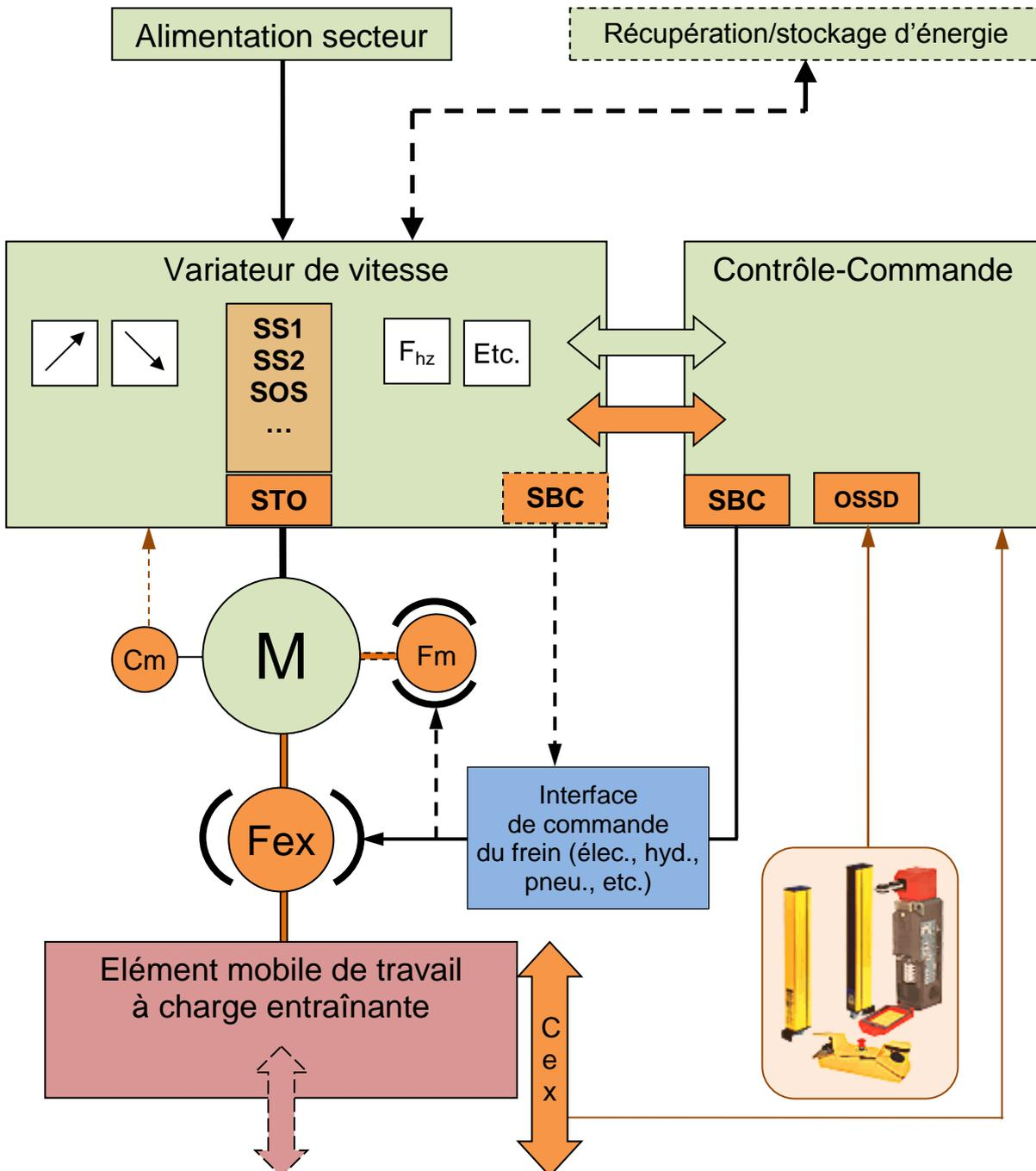
Figure 37 : Intégration d'un PDS/SR dans le circuit de commande d'une presse à servomoteur -
