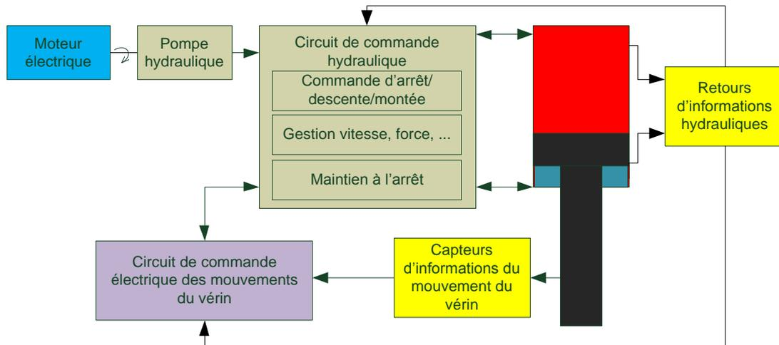
Figure 3 : Exemple schématique de presse hydraulique traditionnelle
