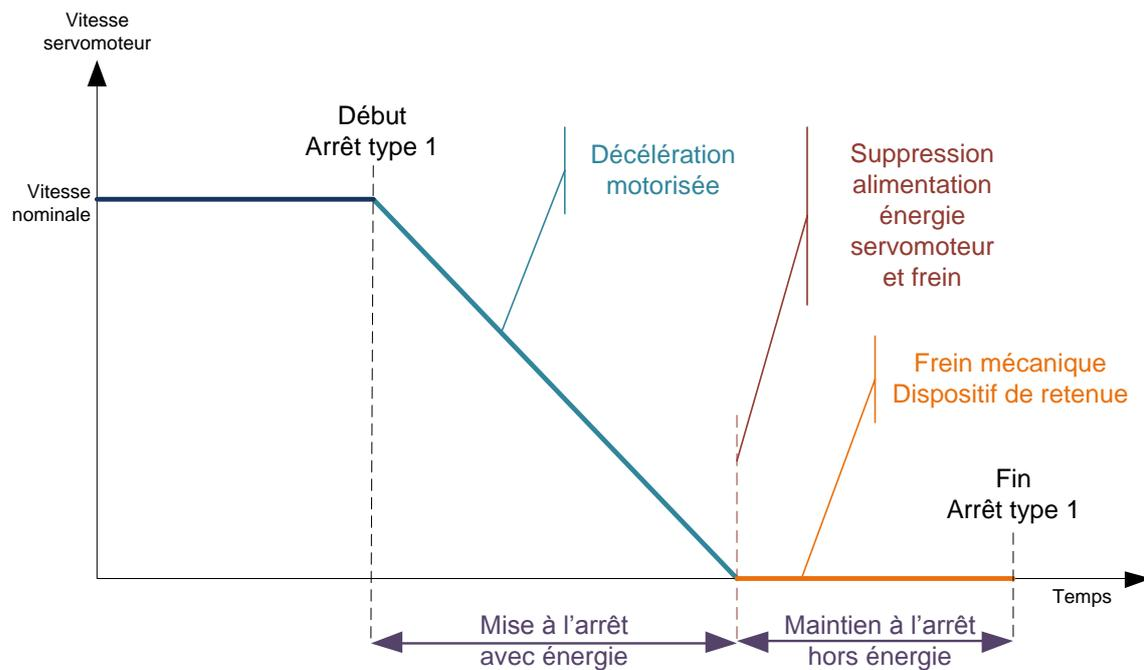
Figure 19 : Chronogramme de principe d'un **arrêt sûr type 1**
