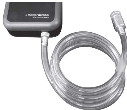
Figure 4 : Exemple de prélèvement d'aérosol déporté
