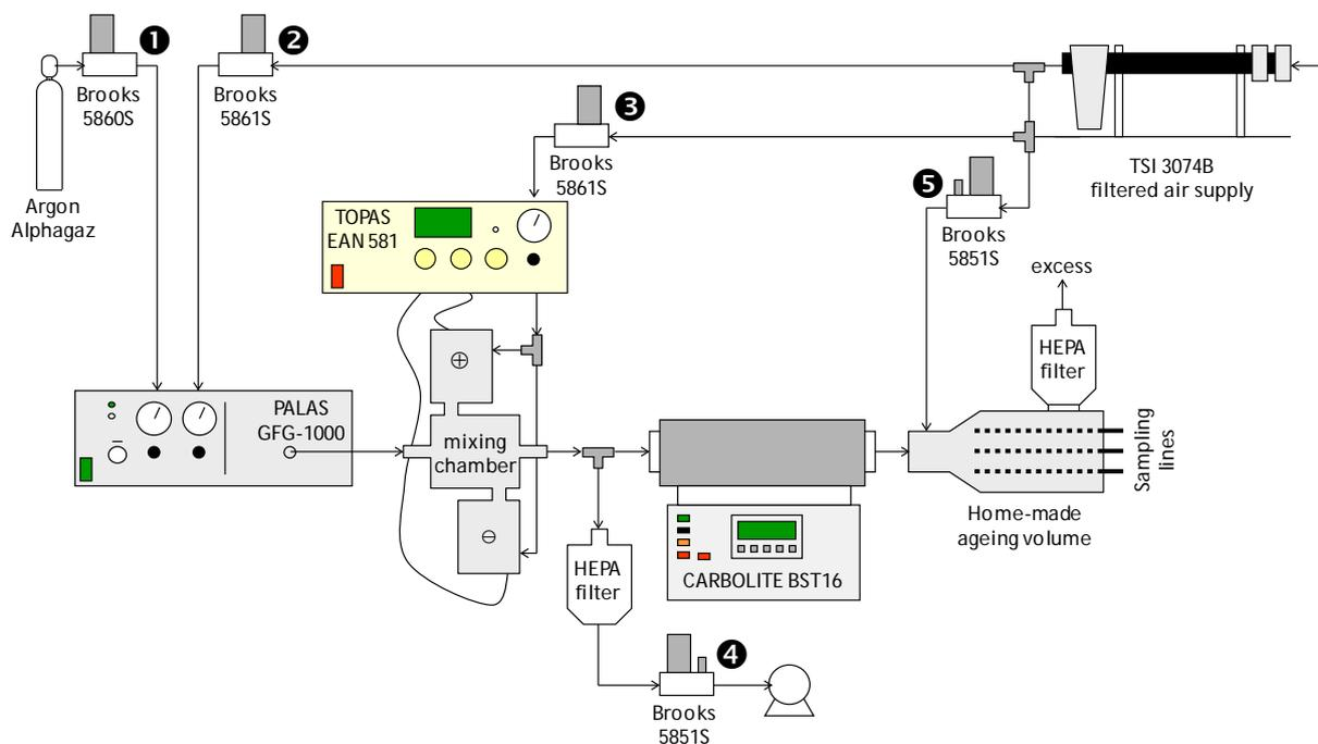
Figure 9 : Schéma du banc d'essais CAIMAN
