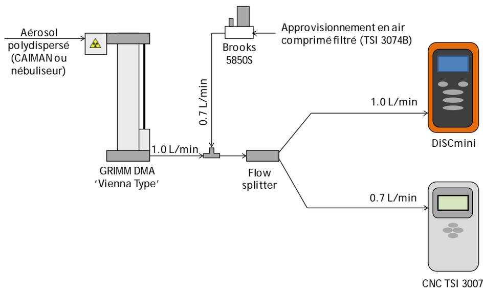
Figure 11 : Schéma du montage en mode monodispersé
