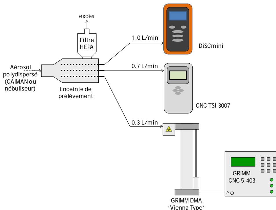
Figure 12 : Schéma du montage en mode polydispersé
