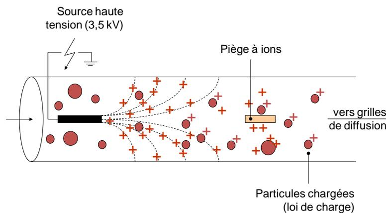
Figure 5 : Schéma de principe du chargeur
