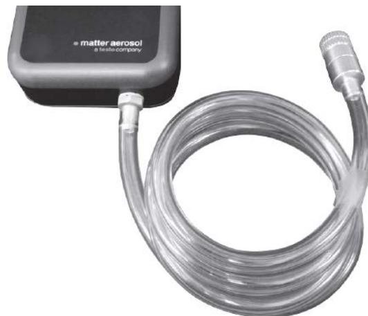
Figure 4 : Exemple de prélèvement d'aérosol déporté
