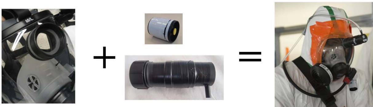
Figure 1 : prototype de masque modifié
