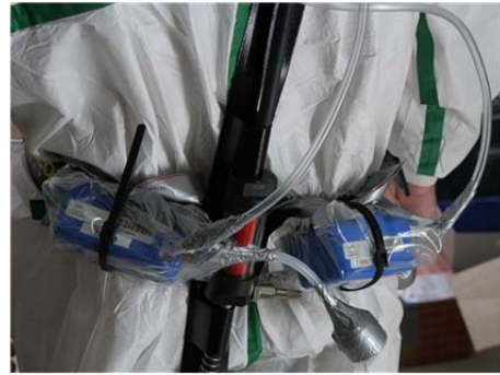
Figure 6 : équipement d'un opérateur Cassettes de prélèvements Pompes de prélèvement individuel
