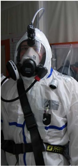
Figure 6 : équipement d'un opérateur Cassettes de prélèvements Pompes de prélèvement individuel
