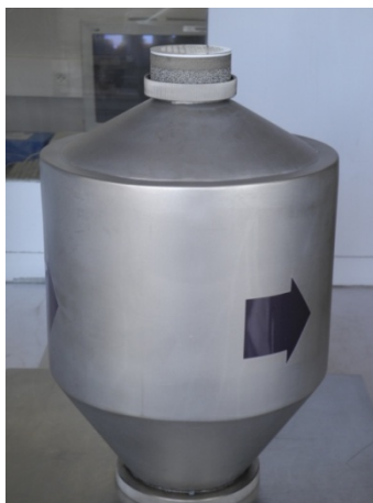
Figure A4, 1 Mise en place des mousses sélectives et du filtre.
