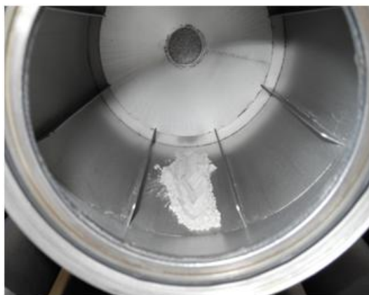
Figure 8 Intérieur du tambour rotatif équipé de pales avec un échantillon de 35 cm 3 de poudre étalé au fond
