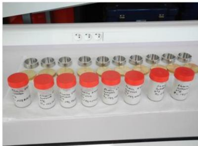
Figure 2 Lots de poudre et cylindres de dosage de volume des échantillons
