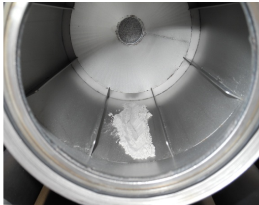
Figure A4, 3 : Positionnement de la poudre dans le tambour.
