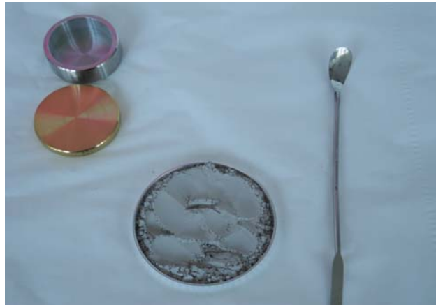
Figure A3 1 Poudre conditionnée dans le porte échantillon
