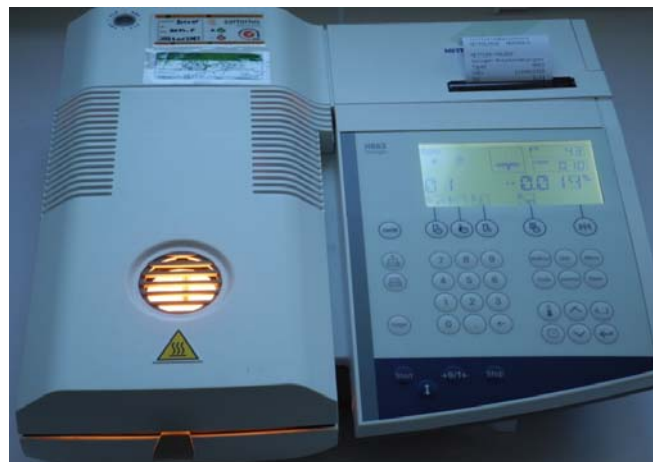
Figure A3, 2 Mesure de la teneur en humidité d'une poudre.
