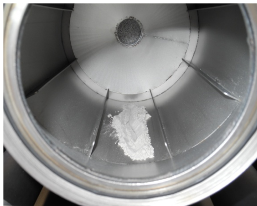
Figure A4, 3 : Positionnement de la poudre dans le tambour.
