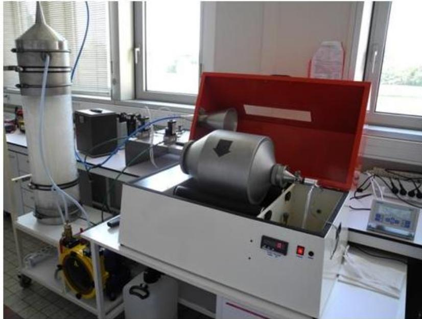
Figure 5 Tambour rotatif pour mesurer la pulvérisation des poudres. A gauche : colonne de traitement d'air en humidité relative.
