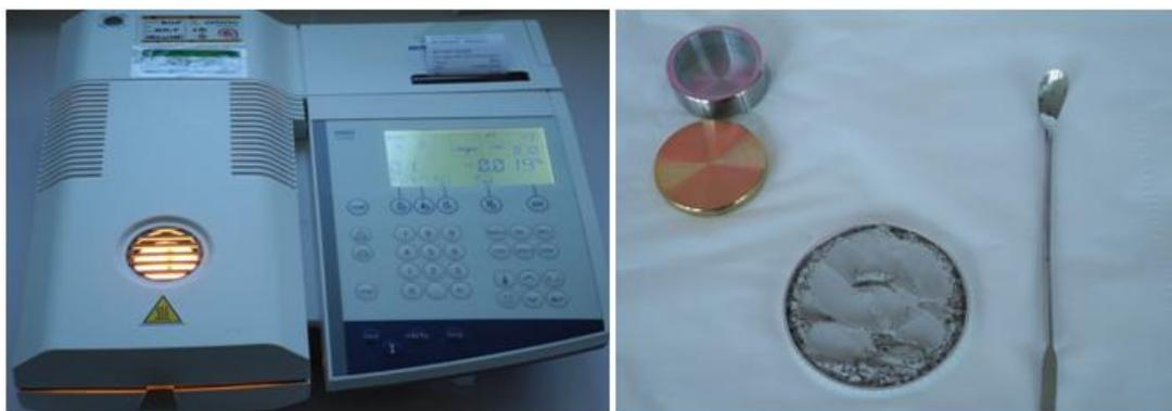
Figure 1 Thermobalance HR83-P METTLER et échantillon de poudre de 35 cm<sup>3</sup>
