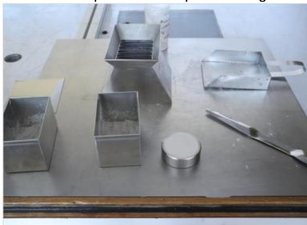
Figure A2, 5 : Cylindre calibré de 35 cm<sup>3</sup> rempli de poudre
