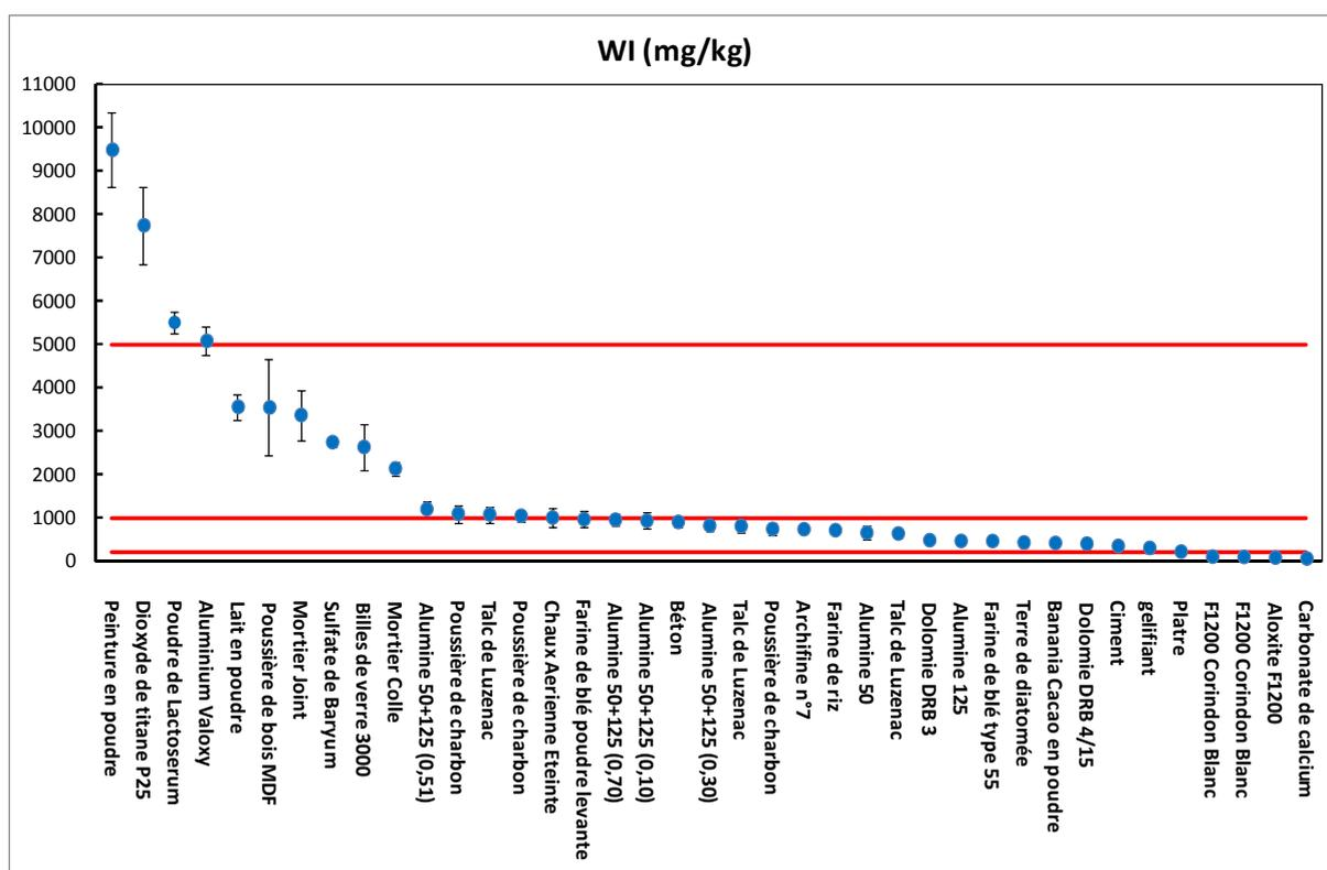
Figure 10 Trois graphiques des indices de pulvérencité pour les poudres indiquées en abscisse. De haut en bas : les indices de pulvérencité Alvéolaire  $W_R$ , Thoracique  $W_T$ , Inhalable  $W_I$ . Les catégories du classement des indices sont matérialisées à l'aide des traits rouges horizontaux.
