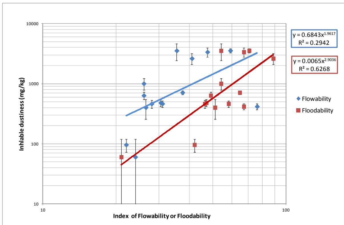
Figure 13 Indice de pulvérulence en fonction de l'indice d'écoulement (flowability) et de l'indice de déferlement (floodability). De haut en bas : les indices de pulvérulence Alvéolaire  $W_R$ , Thoracique  $W_T$ , Inhalable  $W_I$ .
