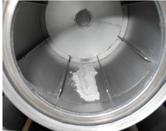
Figure 8 Intérieur du tambour rotatif équipé de pales avec un échantillon de 35 cm<sup>3</sup> de poudre étalé au fond
