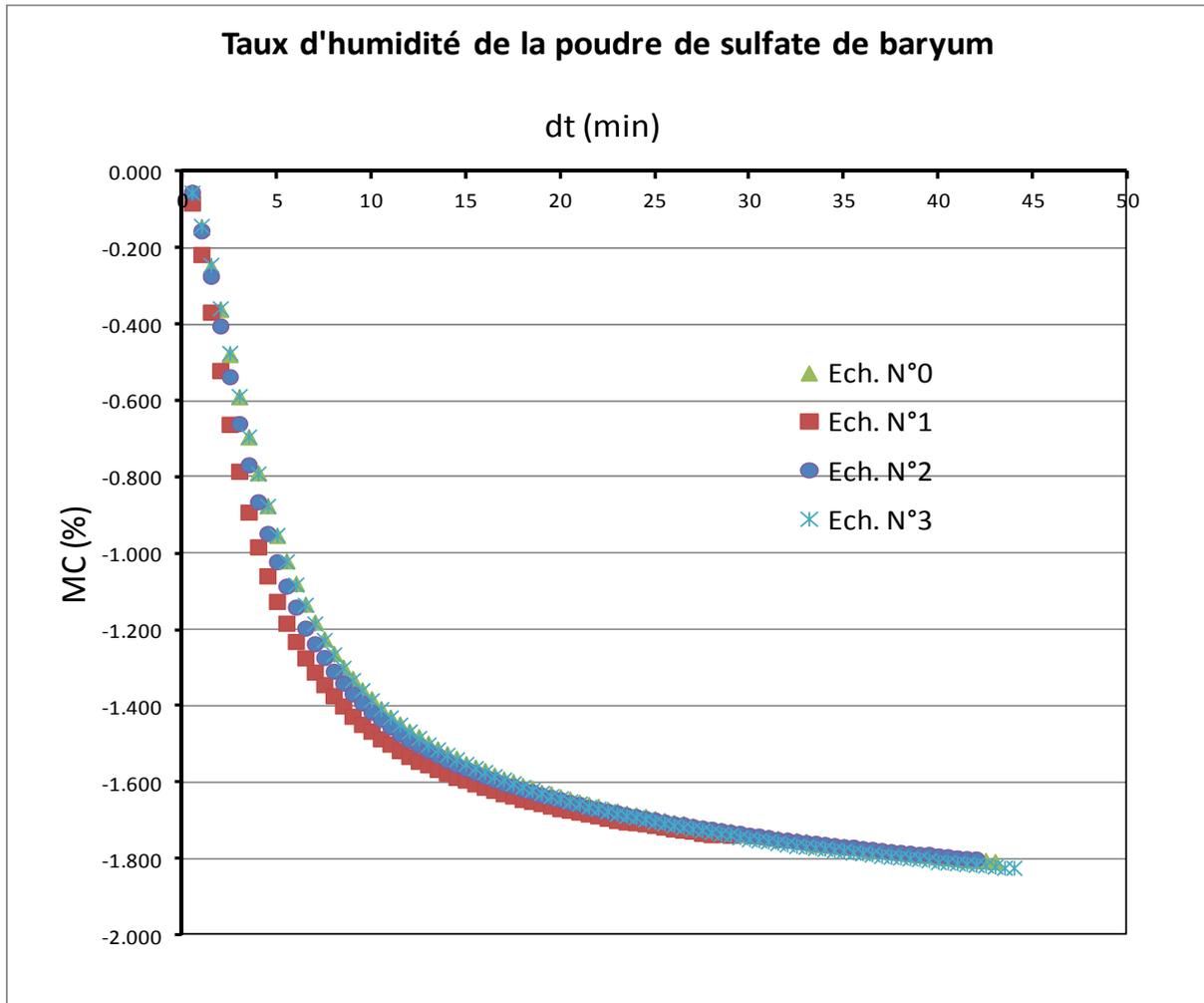
Figure 4 Décroissance de la masse d'un échantillon de poudre du sulfate de baryum chauffée en fonction du temps de chauffage
