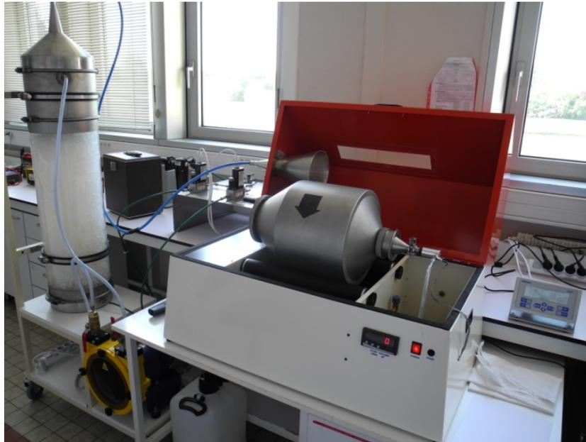
Figure A4, 2 : Banc d'essai du mesurage de la pulvérulence d'une poudre
