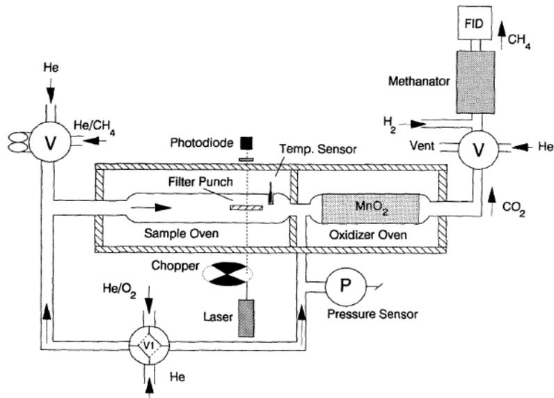
Figure 8 : Représentation schématique d'un analyseur thermo-optique. Le gaz vecteur est sélectionné par la vanne V1, He pur pendant la première étape, ensuite He/O<sub>2</sub> 98/2 pour la seconde étape (Birch M.E. et al., 1996).
