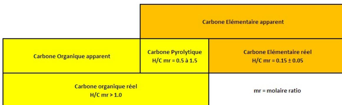
Figure 7 : Représentation schématique du biais engendré par les méthodes thermiques pour la détermination du carbone élémentaire réel
