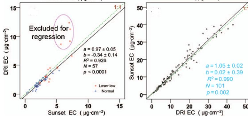
Figures 15 : Comparaison inter-instruments et inter-protocoles du dosage de l'EC : 15<sub>1</sub> en transmission, protocole ACE-Asia ; 15<sub>2</sub> en réflexion, protocole IMPROVE (Wu C *et al.*, 2012).
