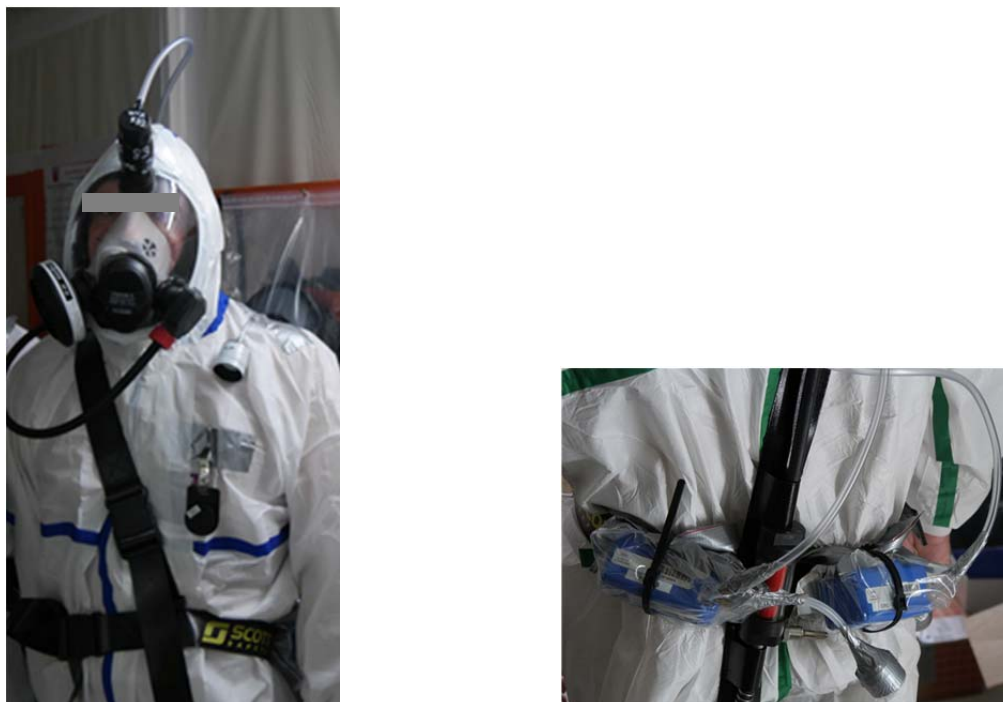
Figure 1. Equipement d'un opérateur Cassettes de prélèvements Pompes de prélèvement individuel
